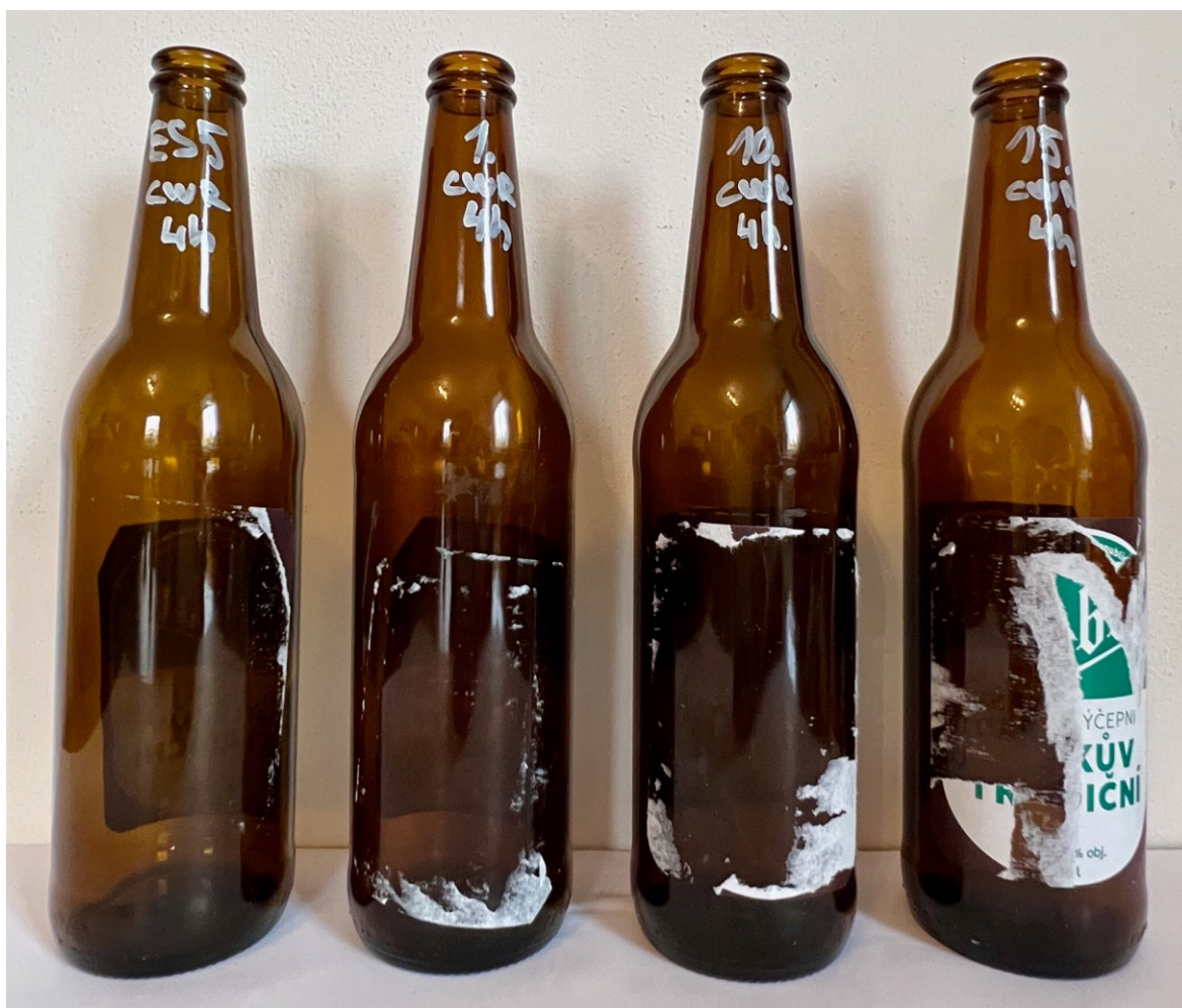
Obrázek 45 Vizuální porovnání zůstatku etikety na láhvi při použití lepidel se škroby po 4 hodinách v klimatické komoře (zleva vzorek reálného lepidla LATYL ES 5 BF, dále pak připravené vzorky č.1, č.10, č.15)
