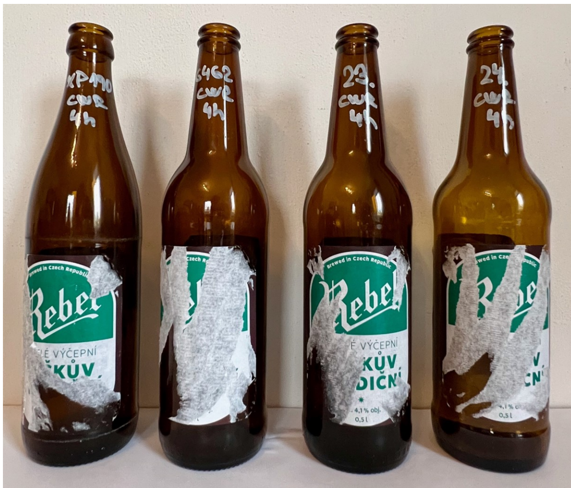
Obrázek 46 Vizuální porovnání zůstatku etikety na láhvi při použití lepidel s obsahem PVA po 4 hodinách v klimatické komoře (zleva vzorky reálných lepidel Henkel Aquence XP 190 a COLLMEX 6462 dále pak připravené vzorky č.23, č.24)
