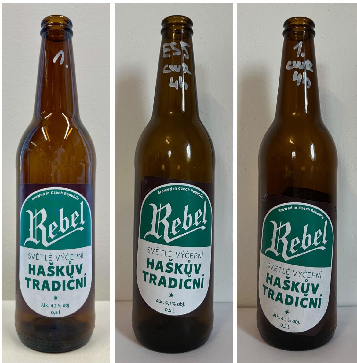
Obrázek 44 Vyhodnocení posunutí etikety na láhvi po 4hodinovém testu (zleva správně nalepena etiketa před zahájením testu v klimatické komoře, dále komerční lepidlo LATYL ES 5 BF a připravený vzorek č.1 kde je viditelné posunutí etiket)
