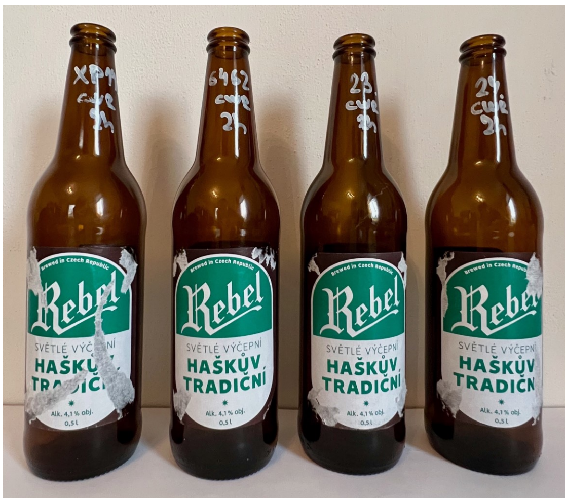
Obrázek 43 Vizuální porovnání zůstatku etikety na láhvi při použití lepidel s obsahem PVA po 2 hodinách v klimatické komoře (zleva vzorky reálných lepidel Henkel Aquence XP 190 a COLLMEX 6462 dále pak připravené vzorky č.23, č.24)
