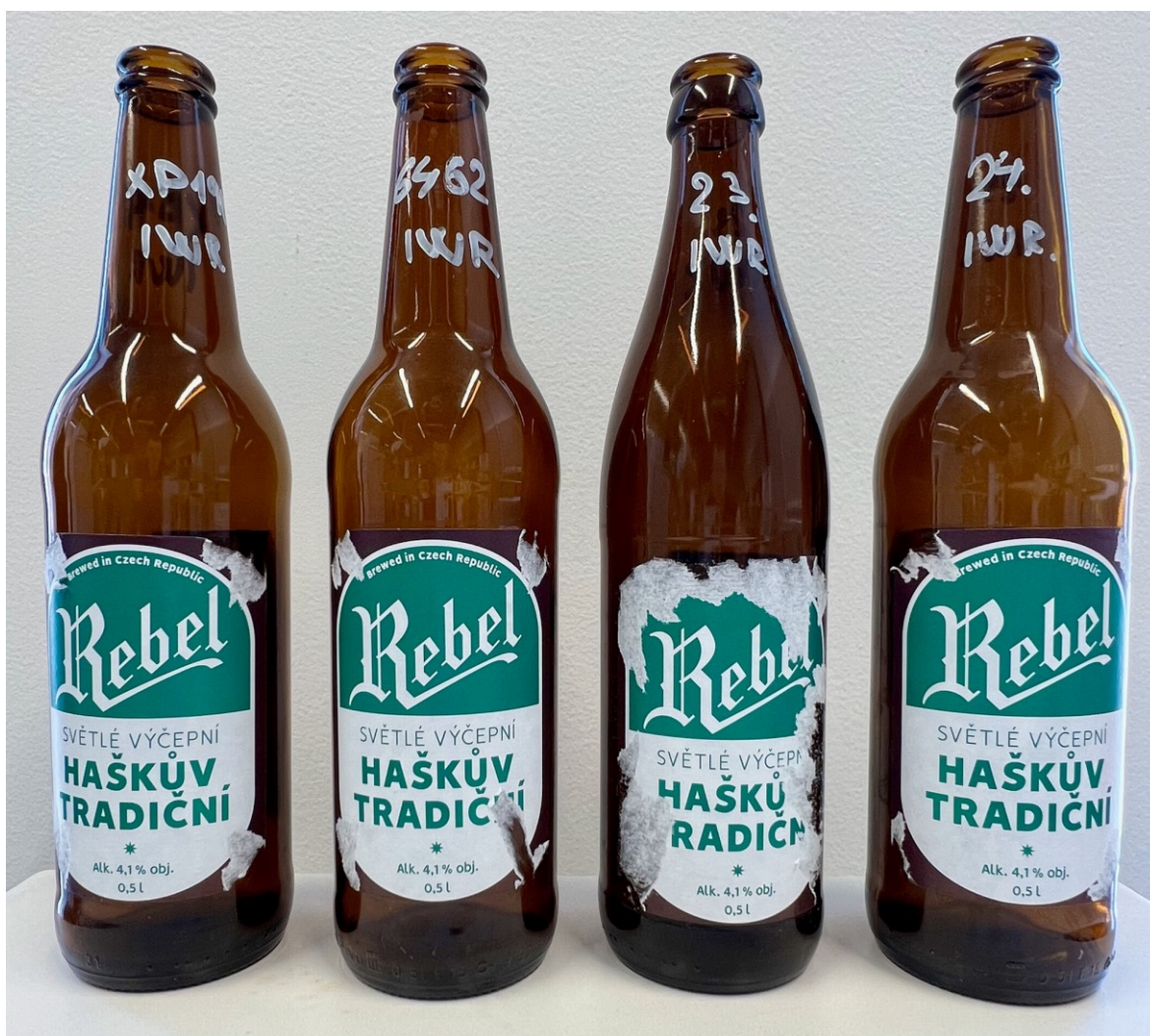
Obrázek 49 Srovnání vzhledu odtržených etiket po testu odolnosti vůči ledové vodě po 24 hodinách (zleva komerční lepidla Henkel Aquence XP 190 a COLLMEX 6462 další dvě láhve jsou připravené vzorky č.23 a č.24)
