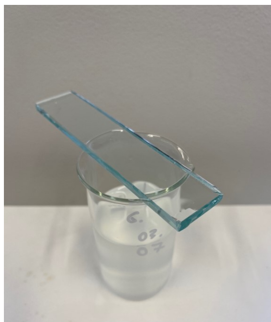
Obrázek 38 Vzorek č.6 s odolností 4 minuty
