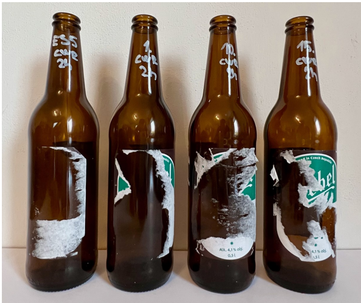
Obrázek 42 Vizuální porovnání zůstatku etikety na láhvi při použití lepidel se škroby po 2 hodinách v klimatické komoře (zleva vzorek reálného lepidla LATYL ES 5 BF, dále pak připravené vzorky č.1, č.10, č.15)
