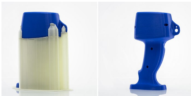
Obr. 19 – Podpůrná konstrukce z HIPS [8]
