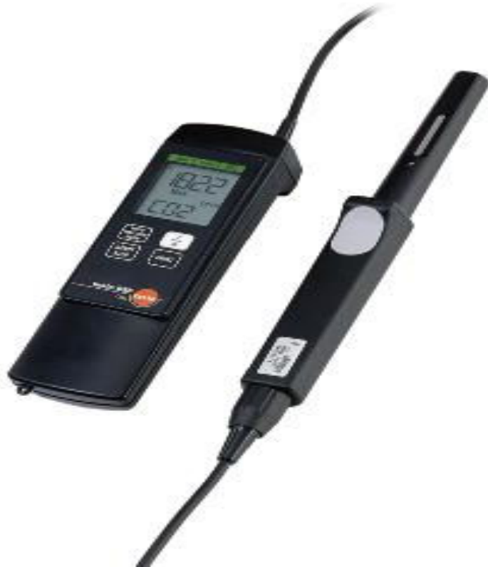
Obrázek 25:TESTO 535 přístroj pro měření koncentrace CO 2 s pevně zabudovanou sondou, baterií a kalibračním protokolem
