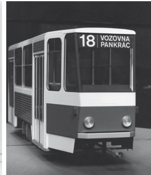
Variantský kresebný návrh a zmenšený model části skříně tramvajového vozu KT 4 od Ivana Linharta a prototyp téhož vozu z roku 1983.
