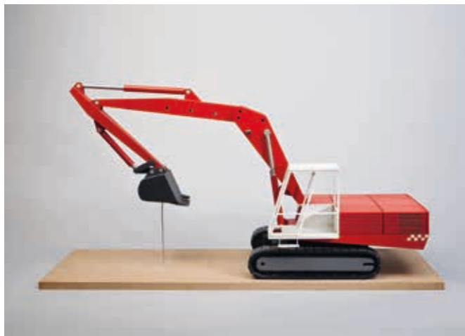
Přelomový návrh prvního československého hydraulického rypadla od Petra Tučného z konce šedesátých let s horizontálním rozložením agregátů.
