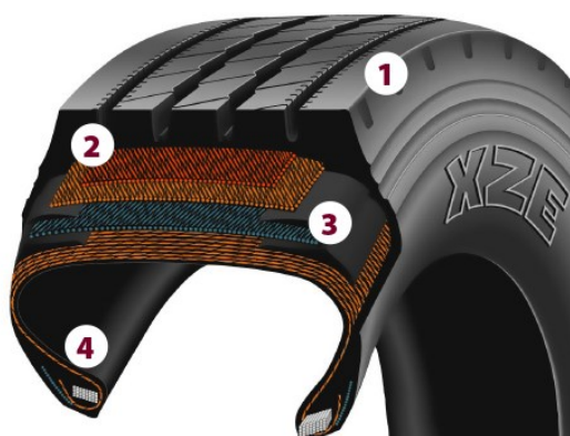
Obrázek 9 – Znázornění kordových tkanin v pneumatice (Kordárna Plus a.s., 2017)
