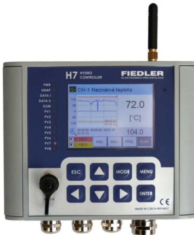
Obrázek 15 – Odolná základní stanice (Tesař, Fiedler, Šír, 2014)
