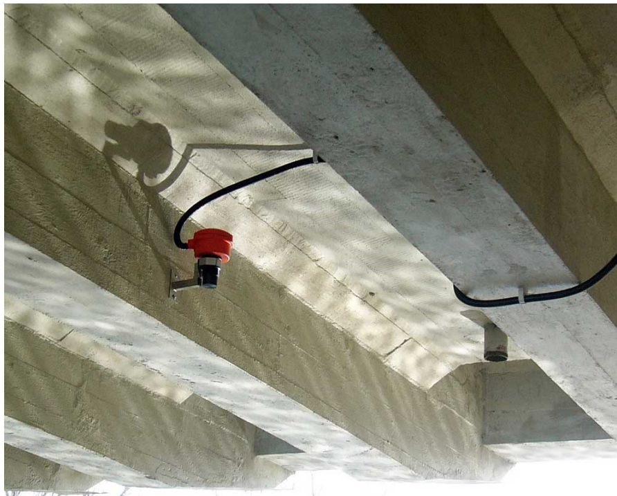
Obrázek 14 – Čidlo limnigrafické stanice (Fiedler.comany, 2023)
