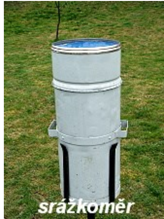
Obrázek 13 – Srážkoměr (Meteorologická stanice Maruška - Hostínské vrchy, 2022)
