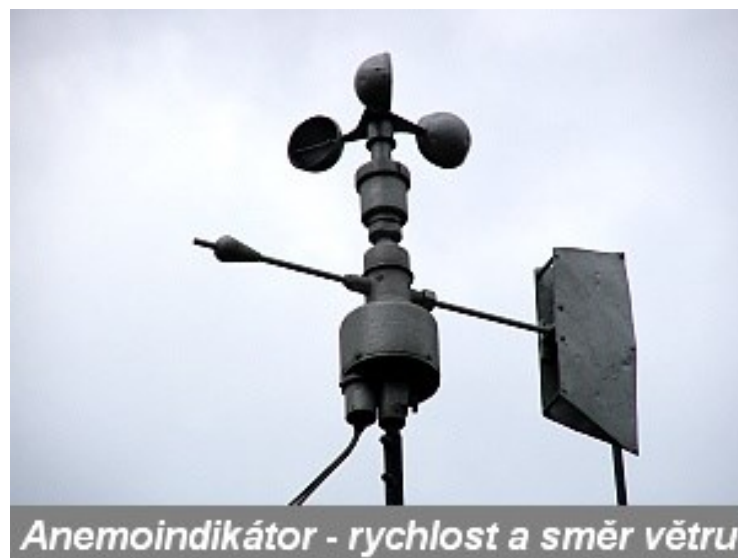
Obrázek 12 – Anemoindikátor – rychlost a směr větru (Meteorologická stanice Maruška - Hostínské vrchy, 2022)
