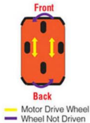
Obrázek 9 Tricycle drive (Orientalmotor, ©2022)
