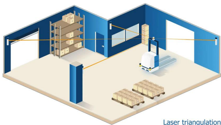
Obrázek 7 Laser triangulation (RAYNER, ©2023)
