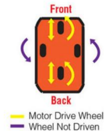
Obrázek 11 Quad drive (Orientalmotor, ©2022)
