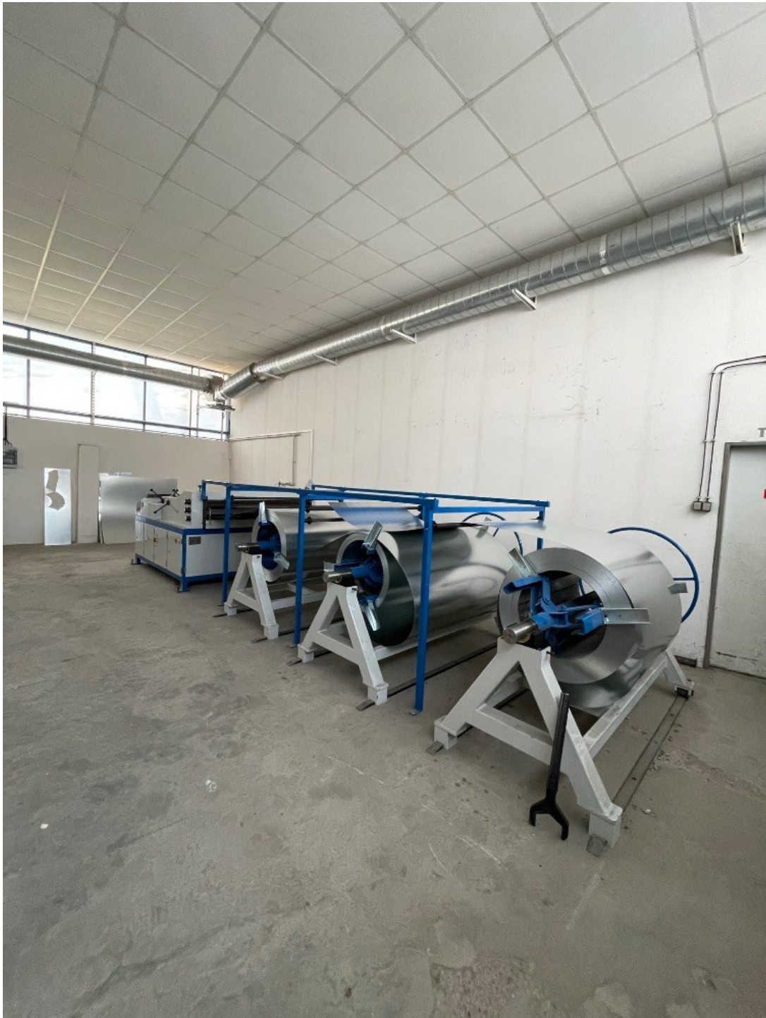
Obrázek 13 Linka LCP na výrobu čtyřhranného potrubí (Zdroj: Vlastní)
