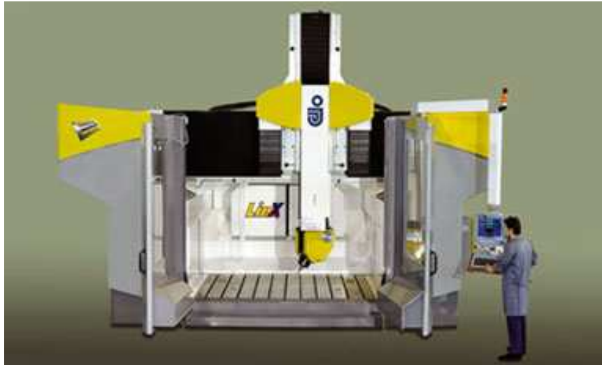
Obr. 2. Stroj s pohonem přímých motorů (JOBS Linx Blitz [17])
