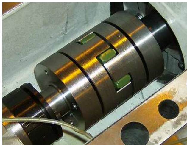
Obr. 15. Spojka motoru a obráběcím stroji (Rotex [19])
