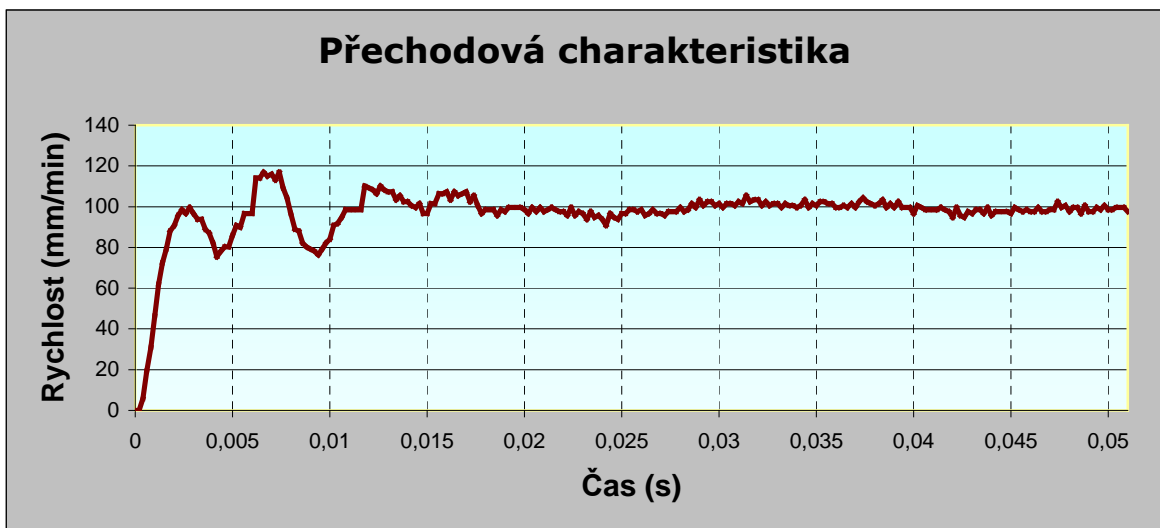
Obr. 33. Přechodová charakteristika svislé osy Z (počátek optimalizace)
