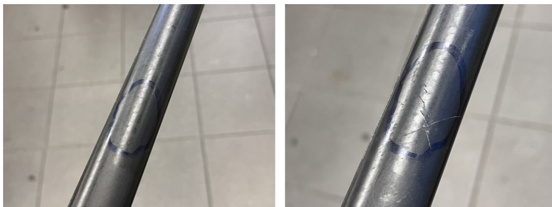
Obr. 79 Karbonová OXDOG hůl před (vlevo) a po (vpravo) rázové zkoušce na padostroji – hmotnost závaží 1400 g
