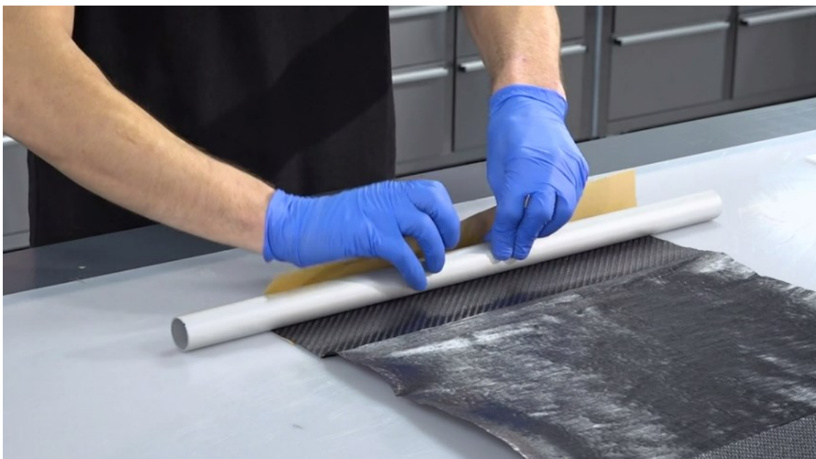
Obr. 10 Nabalování uhlíkových prepregů na kovový trn [18]
