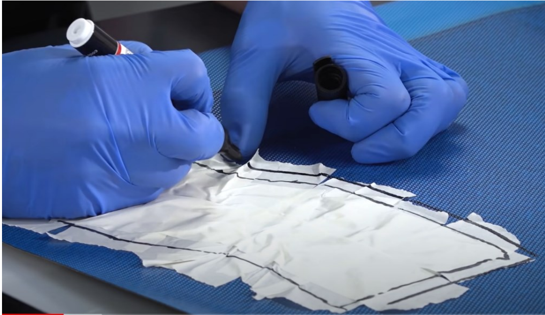
Obr. 16 Nanesení tvaru dutiny na prepreg pomocí maskovací pásky [21]
