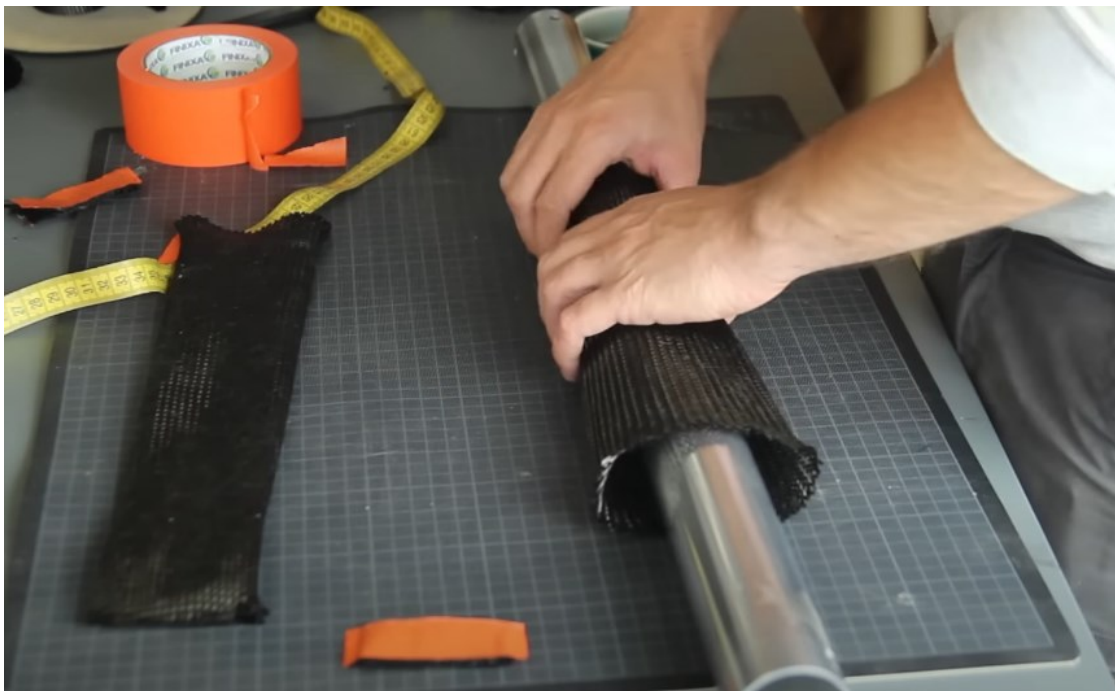
Obr. 13 Navlečení rukávu na trn [19]
