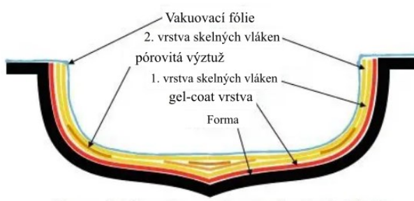
Obr. 28 Vrstvení materiálu do formy na kajak [31]
