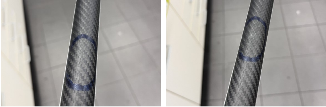
Obr. 71 Třetí prototyp před (vlevo) a po (vpravo) rázové zkoušce na padostroji
