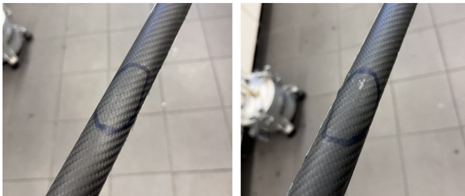
Obr. 76 Čtvrtý prototyp před (vlevo) a po (vpravo) rázové zkoušce na padostroji – hmotnost závaží 950 g
