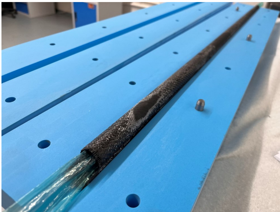
Obr. 46 Odformování po procesu vytvrzování v autoklávu
