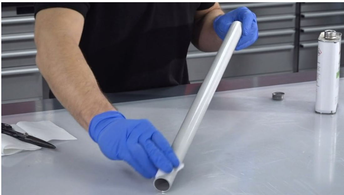
Obr. 9 Příprava a separece kovového trnu [18]
