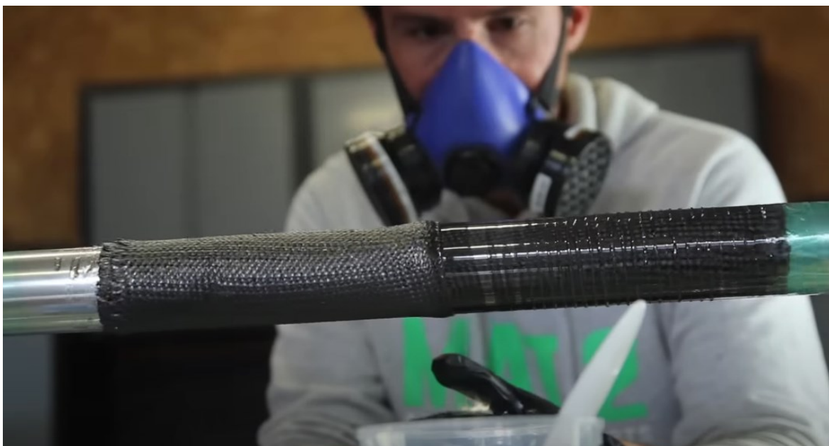
Obr. 15 Navíjení smršťovací pásky [19]
