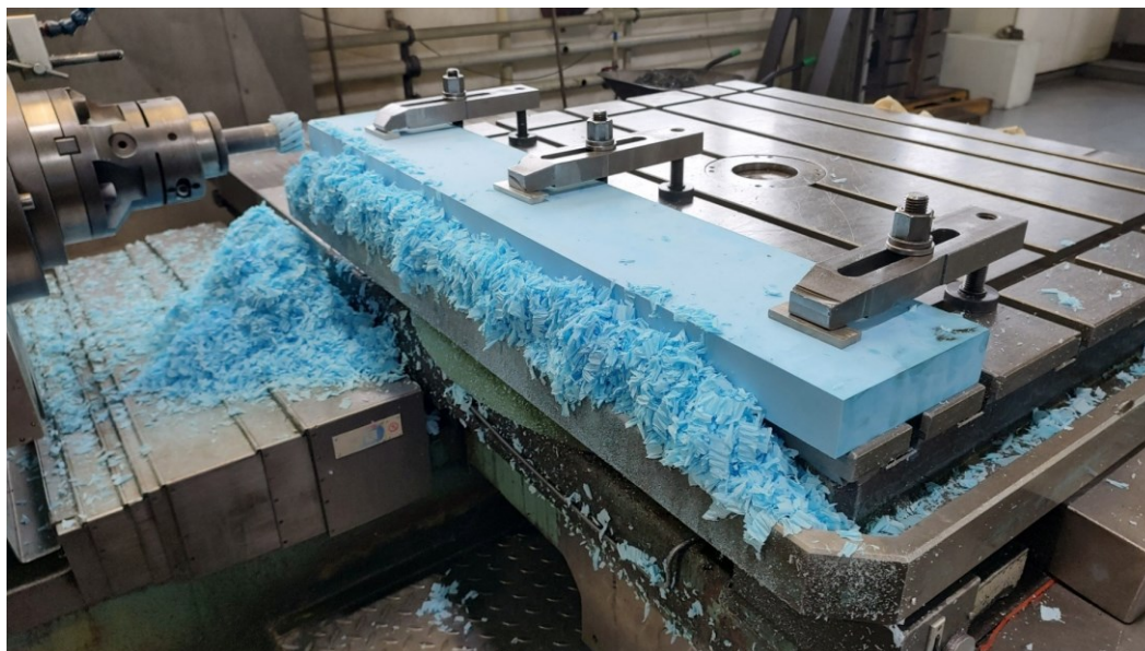
Obr. 37 Obrobený bok upnutého bloku na CNC frézovacím stroji
