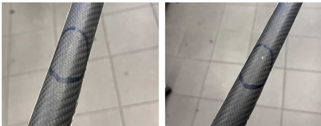
Obr. 75 Čtvrtý prototyp před (vlevo) a po (vpravo) rázové zkoušce na padostroji – hmotnost závaží 621 g
