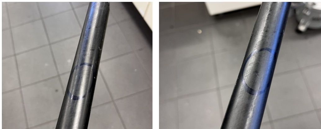
Obr. 74 Karbonová OXDOG hůl před (vlevo) a po (vpravo) rázové zkoušce na padostroji
