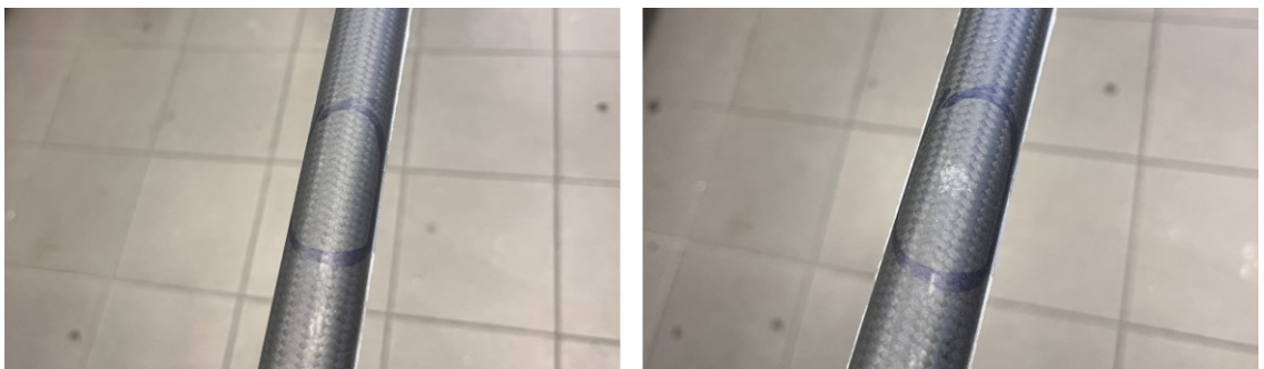
Obr. 73 Pátý prototyp před (vlevo) a po (vpravo) rázové zkoušce na padostroji
