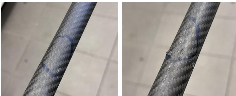
Obr. 77 Druhý prototyp před (vlevo) a po (vpravo) rázové zkoušce na padostroji – hmotnost závaží 1400 g
