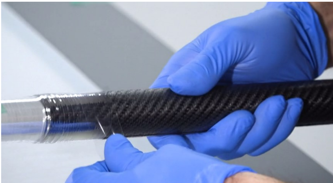
Obr. 11 Obalování navinutého prepregu smršťovací páskou [18]
