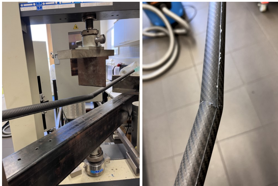
Obr. 61 Zlom při zkoušce ohybem u třetího prototypu
