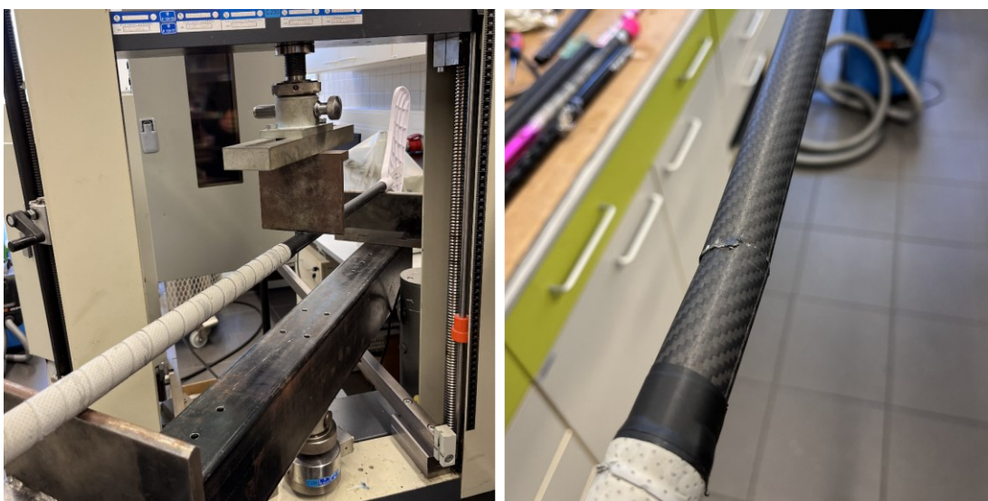
Obr. 59 Testování druhého prototypu (vlevo), místo zlomu (vpravo)
