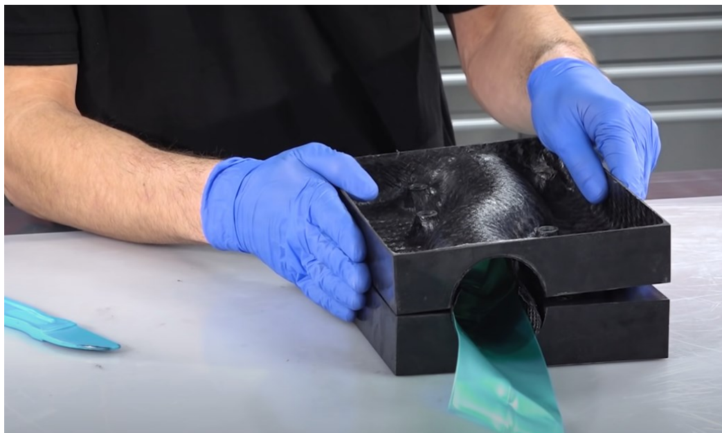
Obr. 18 Fóliový rukáv uvnitř dutiny formy [21]
