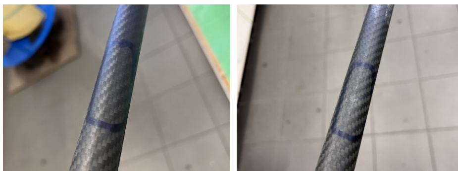
Obr. 70 Druhý prototyp před (vlevo) a po (vpravo) rázové zkoušce na padostroji
