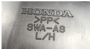
Obrázek 49 Zadní strana krytu s uvedeným materiálem
