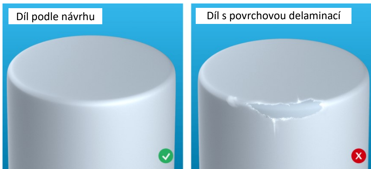
Obrázek 43 Povrchová delaminace (Surface Delamination) [38]
