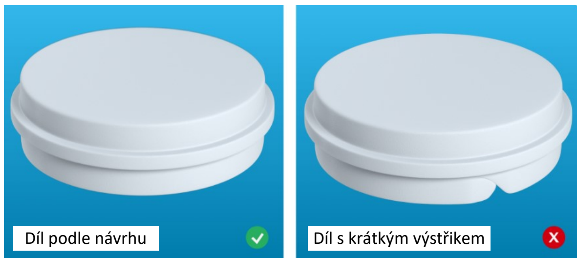
Obrázek 44 Nedotečený výrobek (Short Shots) [38]
