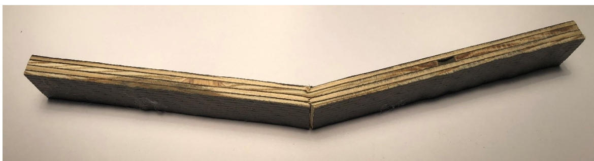
Obrázek 49 Detail tahového porušení vzorku
