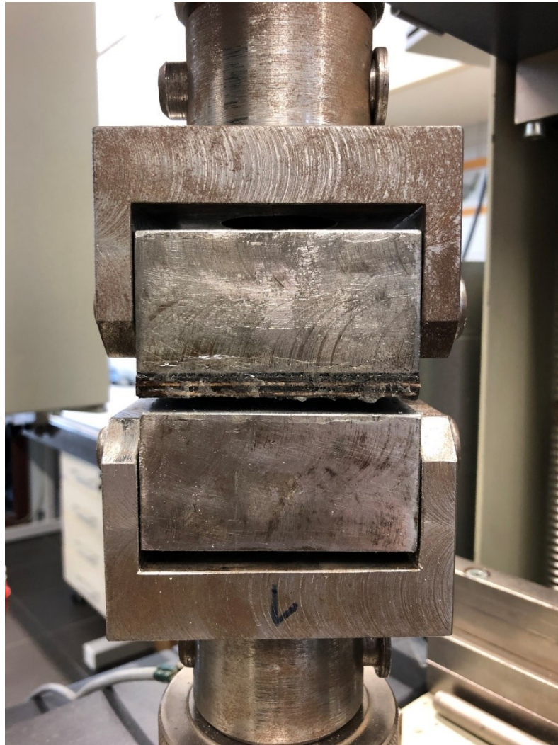
Obrázek 51 Nevhodné porušení vzorku při měření odtrhové pevnosti
