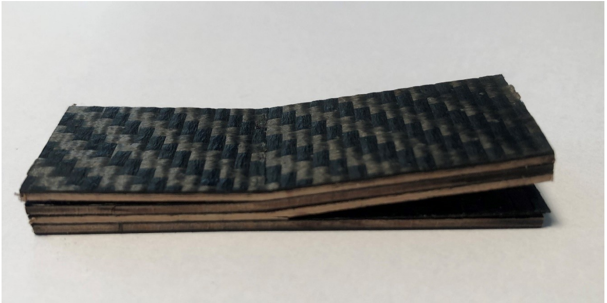
Obrázek 43 Detail porušení vzorku při Short-Beam Testu
