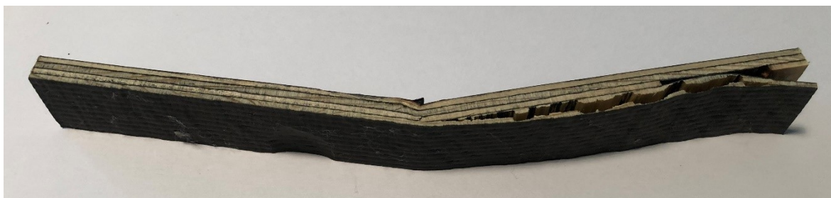
Obrázek 50 Detail mezilaminárního a tlakového porušení vzorku
