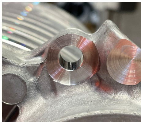
Obr. 36. Vrtání otvoru na OP40.
