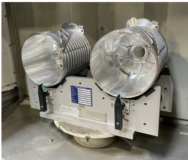
Obr. 29. Upnutí dílů ve vysokotlaké pračce.
