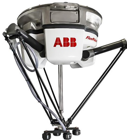
Obrázek 12: Delta uspořádání robota [21]
