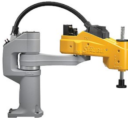
Obrázek 11: Scara uspořádání robota [19]
