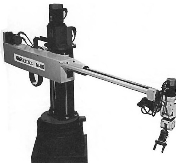
Obrázek 10: Cylindrické uspořádání robota [19]
