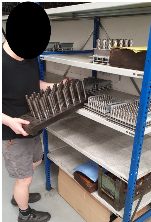
Obrázek 11 Manipulace s polotovary fréz (vlastní zpracování)
