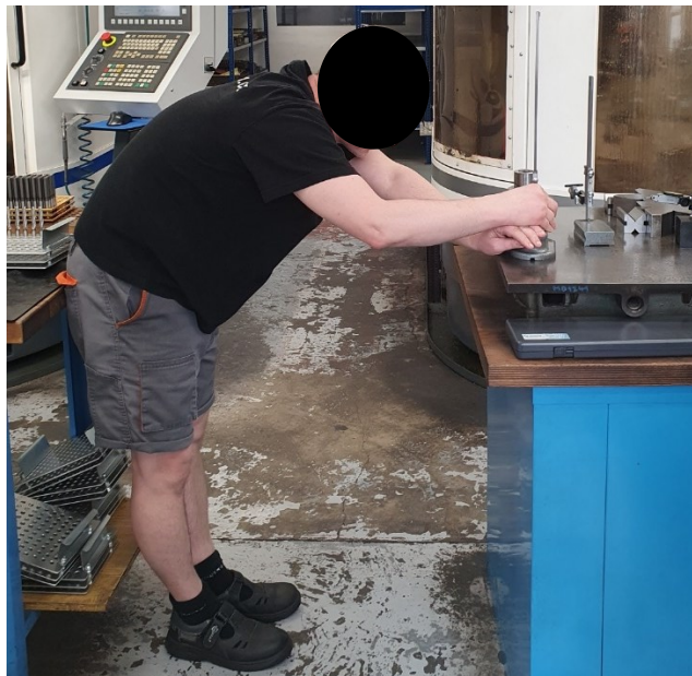
Obrázek 13 Měření brusného kotouče (vlastní zpracování)
