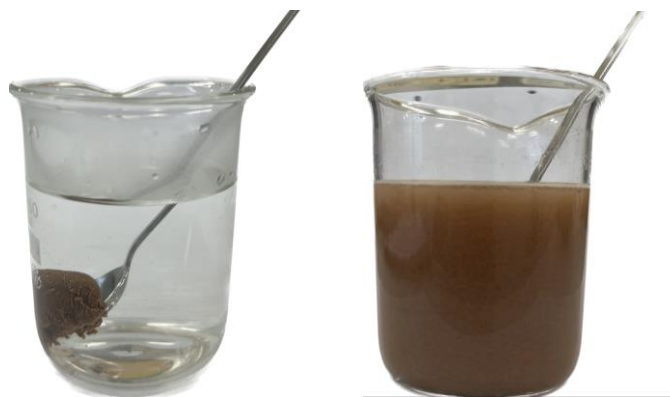
Obrázek 6: Ganáž před a po promíchání, mísení s vodou dokazuje emulzi typu olej ve vodě
