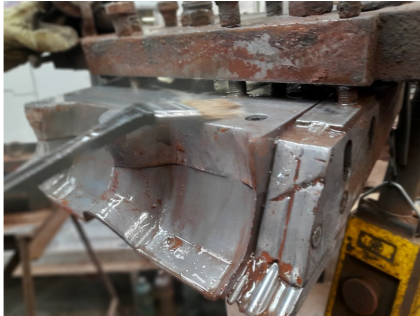
Obrázek 27 Nanášení separačního oleje na očištěné ústí (vlastní zpracování)
