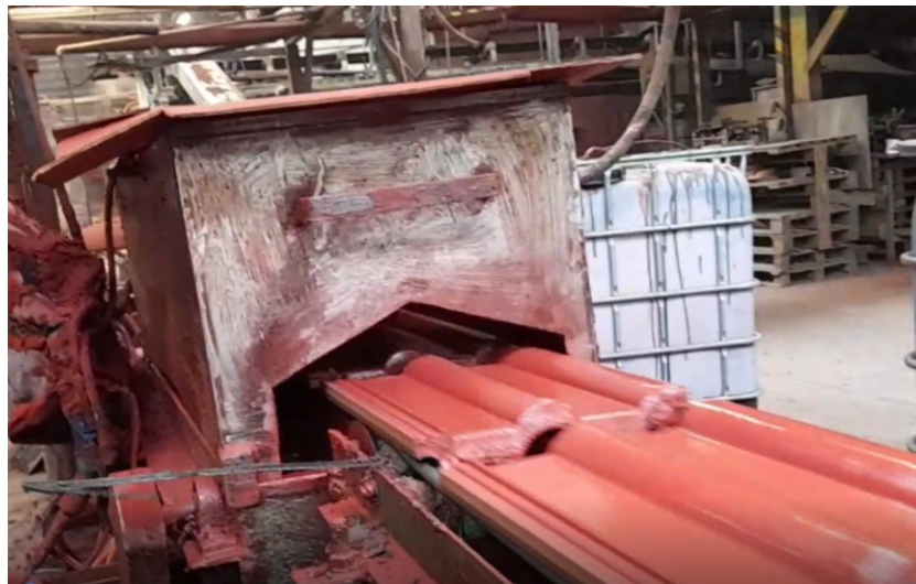
Obrázek 29 Výstup nabarvených tašek z komory (vlastní zpracování)
