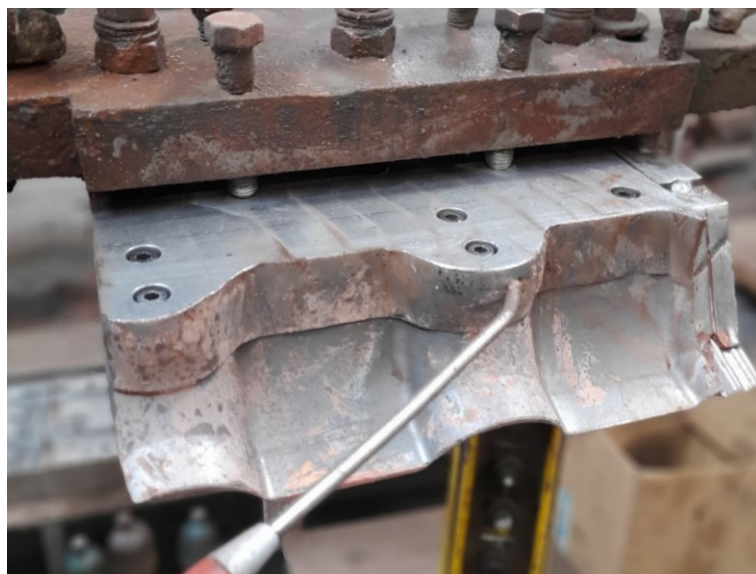
Obrázek 20 Snímek zachycuje čištění ústí (vlastní zpracování)
