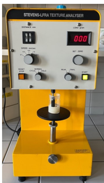
Obrázek 6: Analyzátor textury; Mechtric Stevens-LFRA Texture Analyzer
