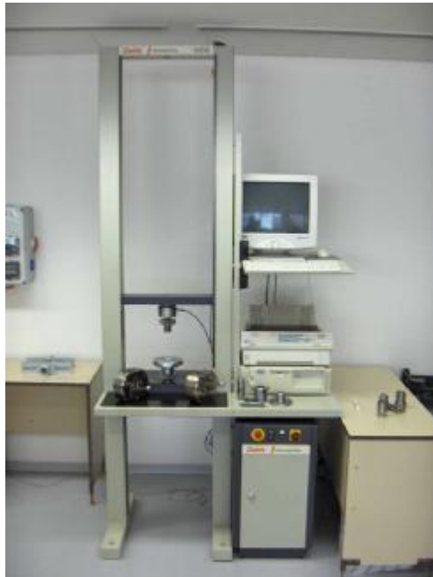
Obr.10.: Zkušební stroj Zwick (bez upnutých čelistí) s počítačem vyhodnocujícím jeho činnost
