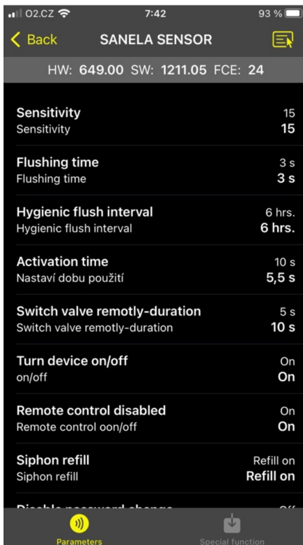
Obrázek 66 Aplikace Sanela Control
