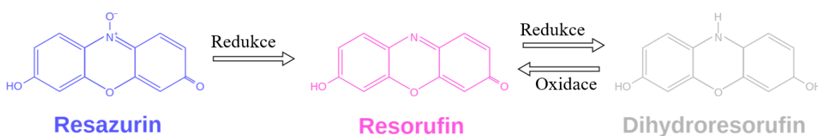
Obrázek 15 – fotoindukovaná redukce resazurinu doprovázena barevnými přeměnami [61]
