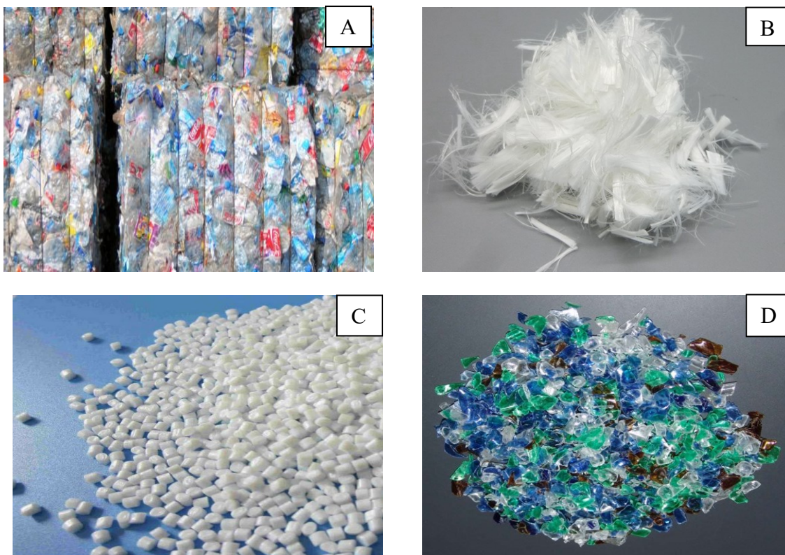
Obrázek 16 – Zpracovatelské formy recyklovaného polyethyltereftalátu A [34], B [35], C [36], D [37]
