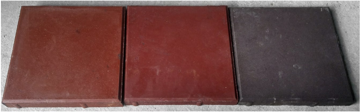
Obrázek 23 – Zámková dlažba vyrobená z Polybetu [48]
