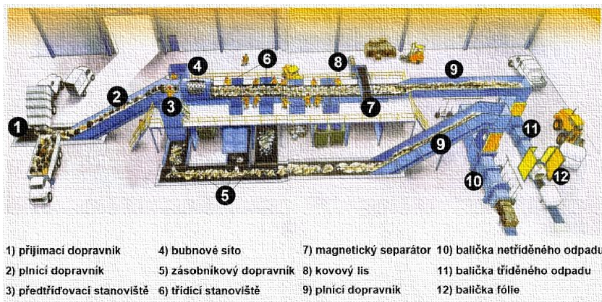
Obrázek 14 – Schéma třídící linky plastových výrobků [32]
