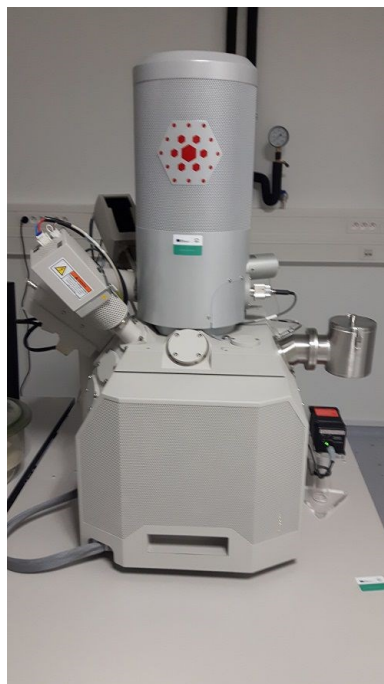
Obrázek 54 - Použitý skenovací elektronový mikroskop Nova NanoSEM 450 (FEI)
