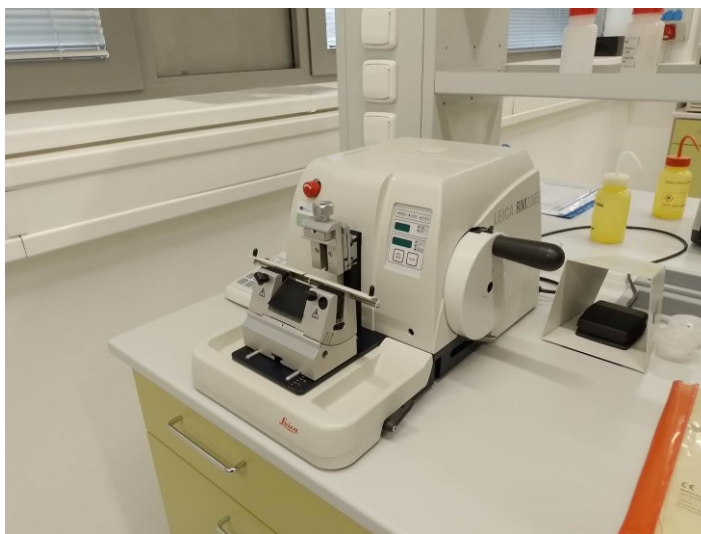
Obrázek 51 - Použitý rotační mikrotom Leica RM2265 pro přípravu tenkých vrstev
