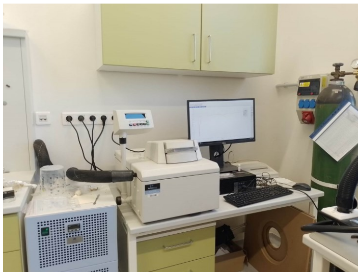
Obrázek 52 - Použitý difenziální skenovací kalorimetr Pyris 1 od firmy PerkinElmer
