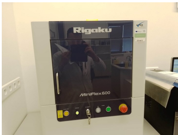
Obrázek 53 - Použitý difraktoměr s rentgenovým zářením Rigaku MiniFlex 600
