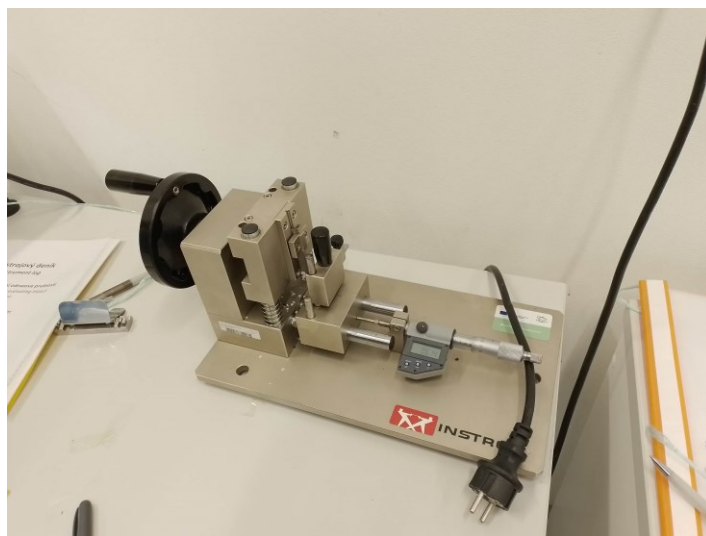
Obrázek 48 - Použité vrubovací zařízení Notchvis, sloužící pro přípravu vzorků na zkoušku Charpyho kladivem
