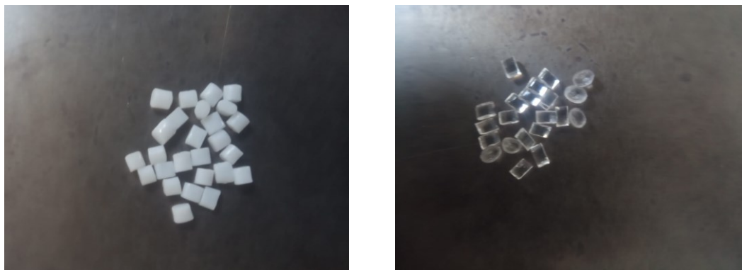
Obrázek 5 – Granulát semikrystalického PET (vlevo) a amorfního PET (vpravo)
