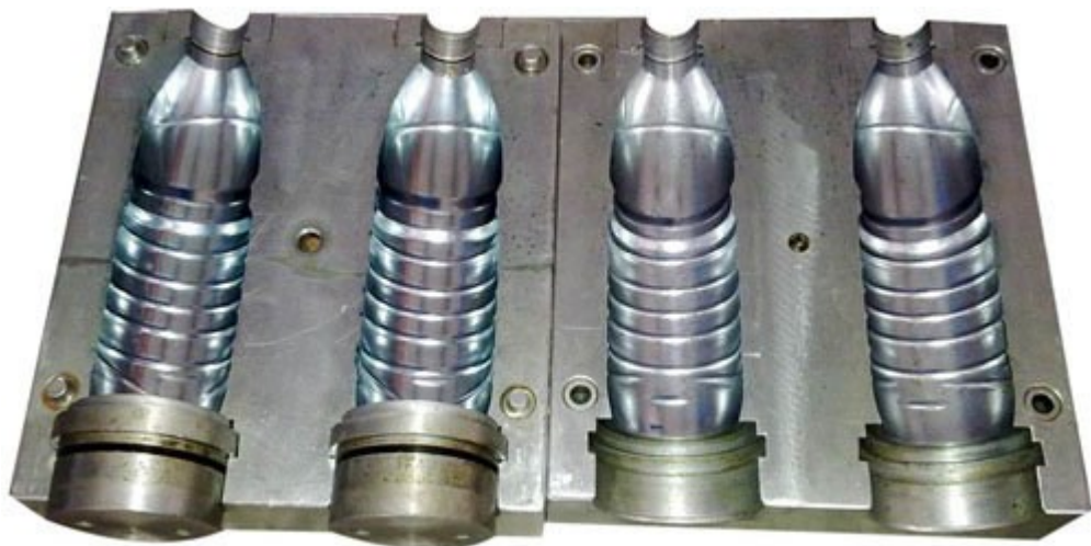
Obrázek 8 – Příklad formy na vyfukování PET lahví od firmy Suzhou Sipa Technology [16]
