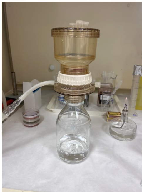
Obrázek 2 Aparatura pro membránovou filtraci (archiv autorky)
