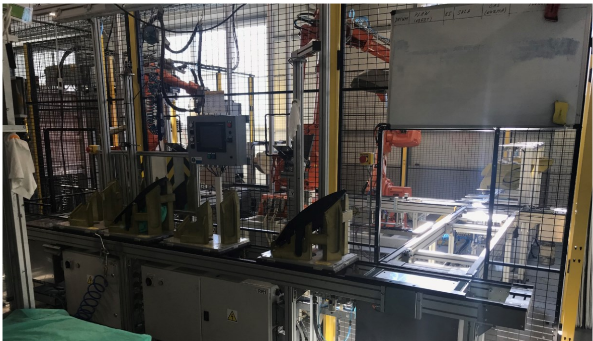
Obrázek 14 – Robotické pracoviště lepení světlometů (vlastní zpracování)
