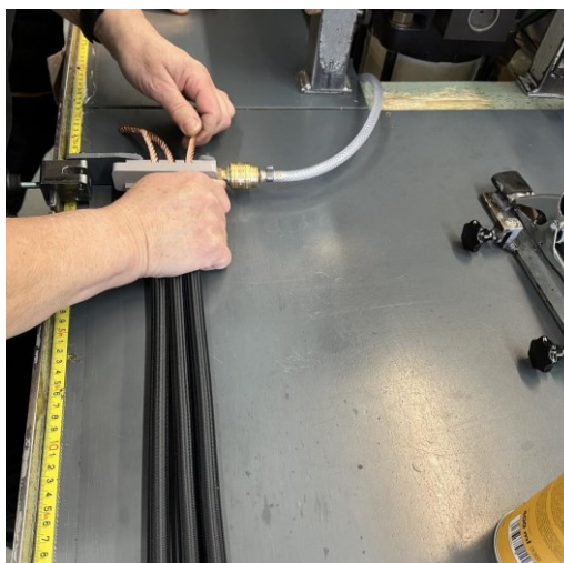
Obrázek 17 Nový návrh přípravku na nasunutí měděného lanka do hadice (vlastní zpracování)
