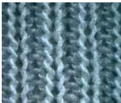
Obrázek 21 Oboulícní zátažná pletenina – v mírně napnutém stavu
