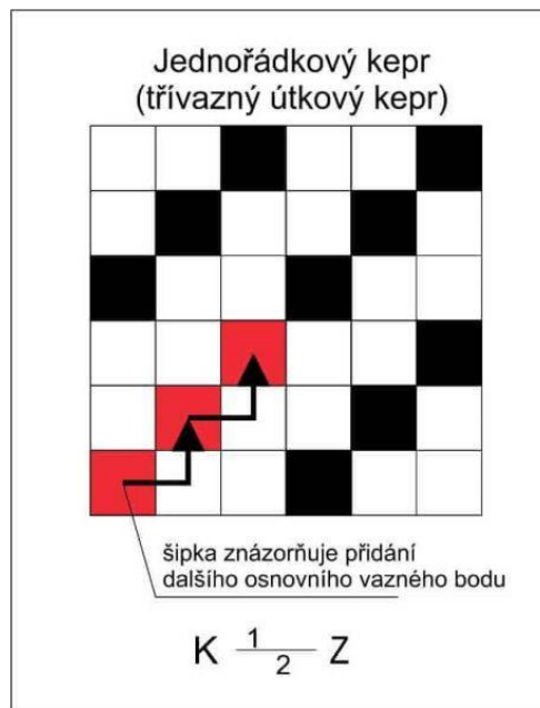
Obrázek 13 Schéma keprové vazby
