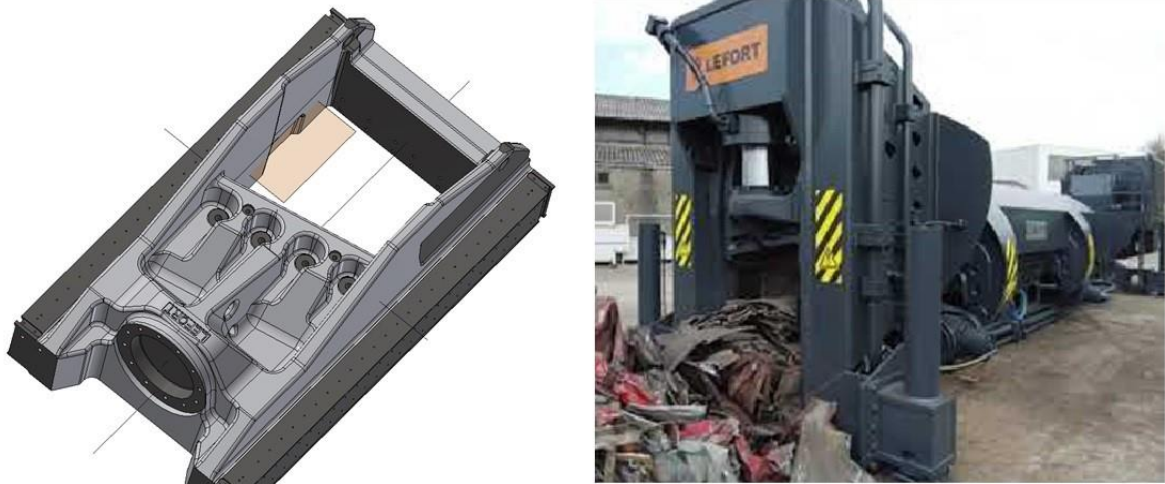
Obrázek 11 : Odlitek drtiče hmotnost 13 000 Kg na drtící stroj na šrot (Vlastní zpracování dle UNEX, 2023)
