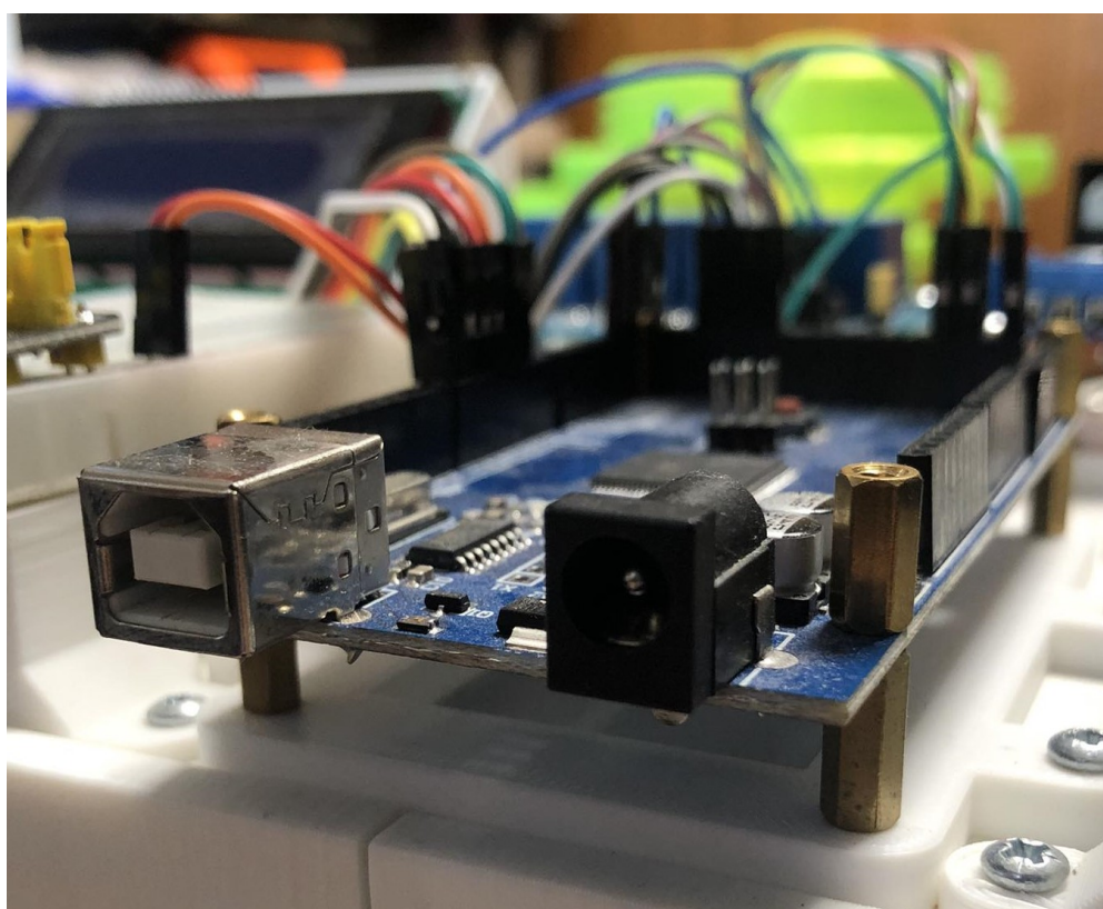
Obrázek 66 Arduino Mega připevněné na platformě pomocí tištěného držáku
