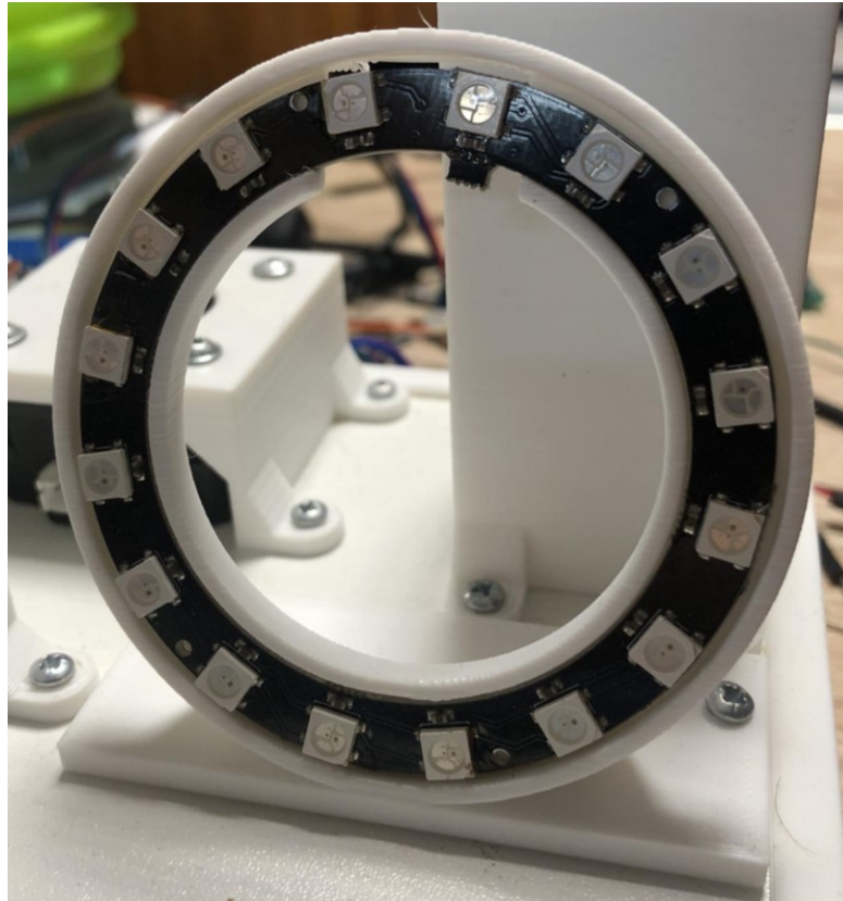
Obrázek 60 Držák RGB LED kruhu osazený modulem RGB
