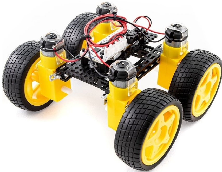
Obrázek 29 Sada podvozku auta řízená přes telefon pomocí Bluetooth [28]
