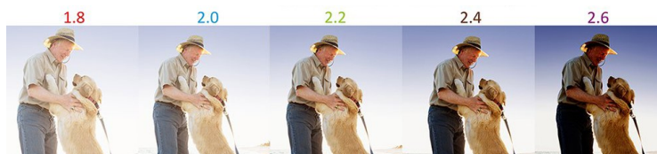
Obrázek 22 Porovnání využití EOTF gamma křivek na obsahu 83
