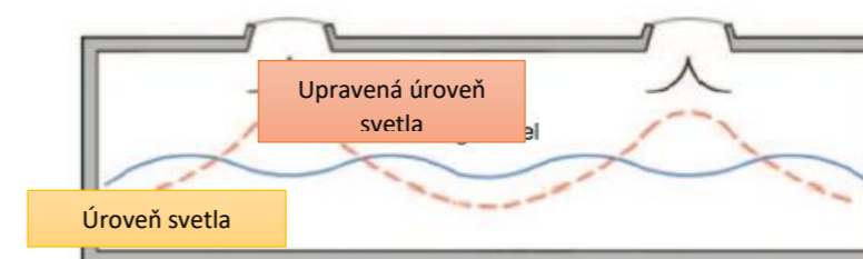
Obrázok 6 - Upravený vzor prieniku denného svetla so zariadením na vychyľovanie svetla pod svetlíkom [13]
