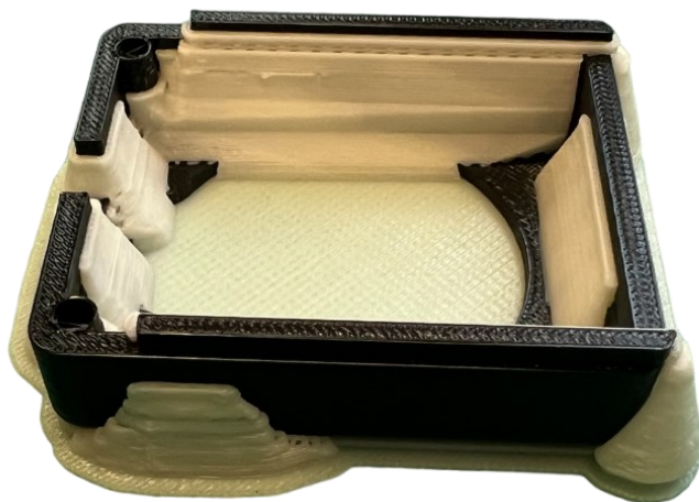
Obr. 50 Vytištěný dolní kryt s podpůrnými strukturami [vlastní]
