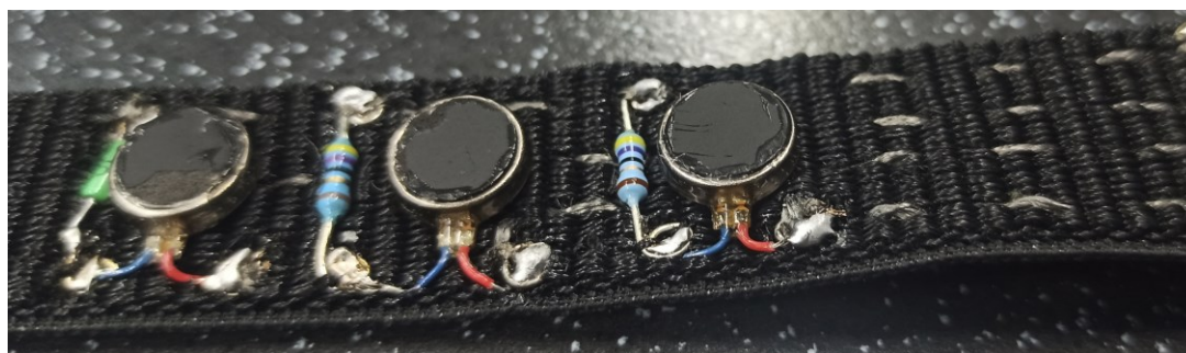
Obr. 57 pohled na propojené vibrační motůrky [vlastní]
