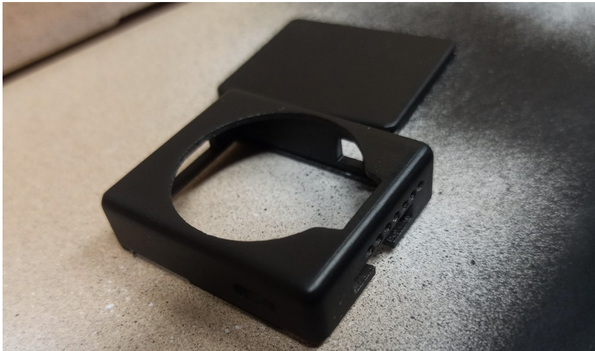
Obr. 54 Horní a dolní kryt po finální povrchové úpravě [vlastní]
