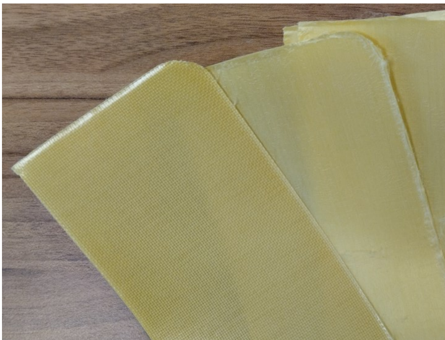
Obrázek 23 Vrstvy měkké balistiky – tlustší (nalevo) a tenčí (napravo) [vlastní]
