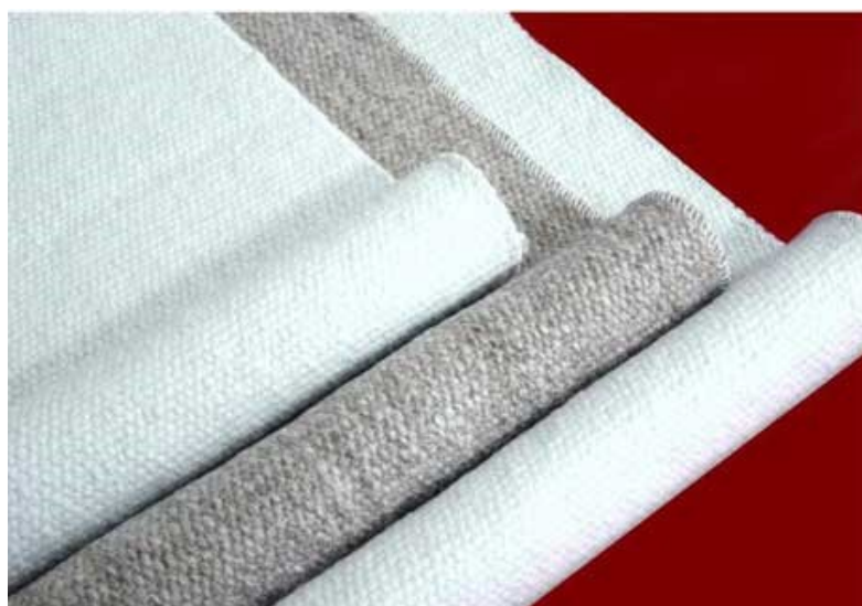
Obrázek 15 Balistický materiál – keramické vlákno tkané [26]
