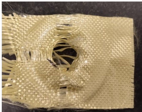
Obrázek 33 Vzorek z jednoho plátu aramidové tkaniny style 281 [vlastní]
