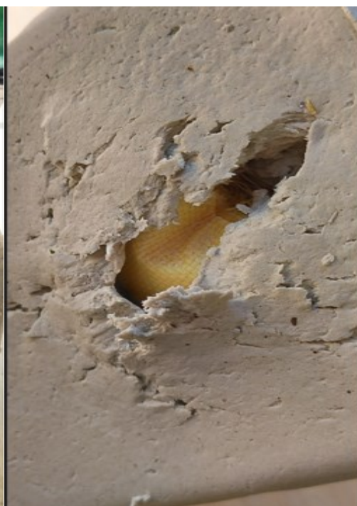
Obrázek 43 Originální kompozit – pohled ze zadní hmoty [vlastní]
