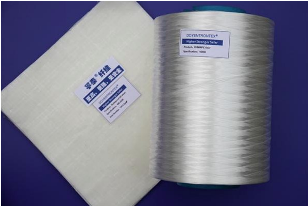
Obrázek 10 Balistický materiál polyetylenová vlákna s ultra vysokou molekulární hmotností [22]
