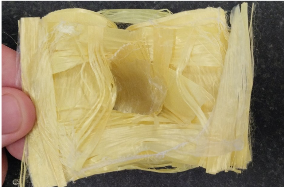
Obrázek 26 Proražený vzorek 5 slabších aramidových plátů [vlastní]
