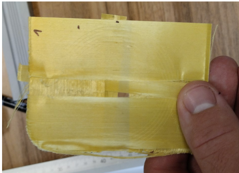
Obrázek 25 Proražený samotný slabší aramidový plát [vlastní]
