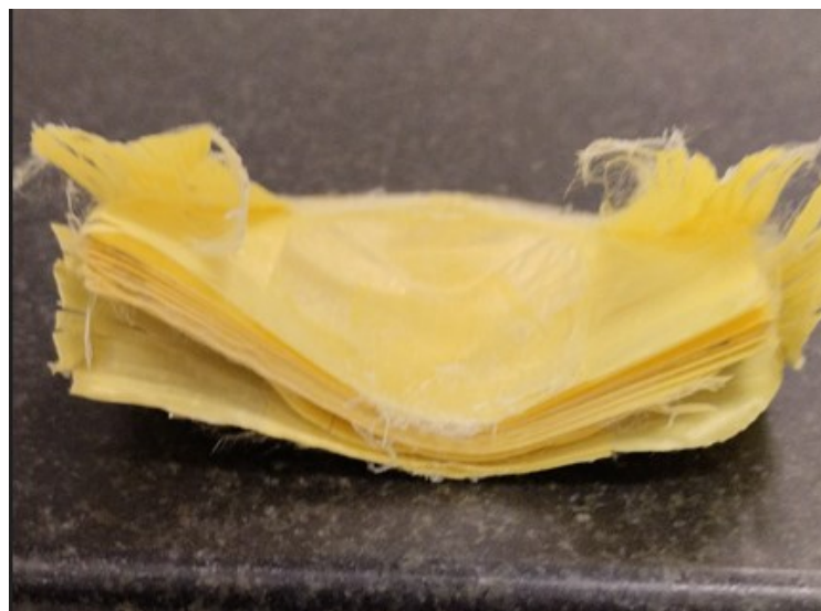
Obrázek 27 Vzorek 10 slabších aramidových plátů [vlastní]
