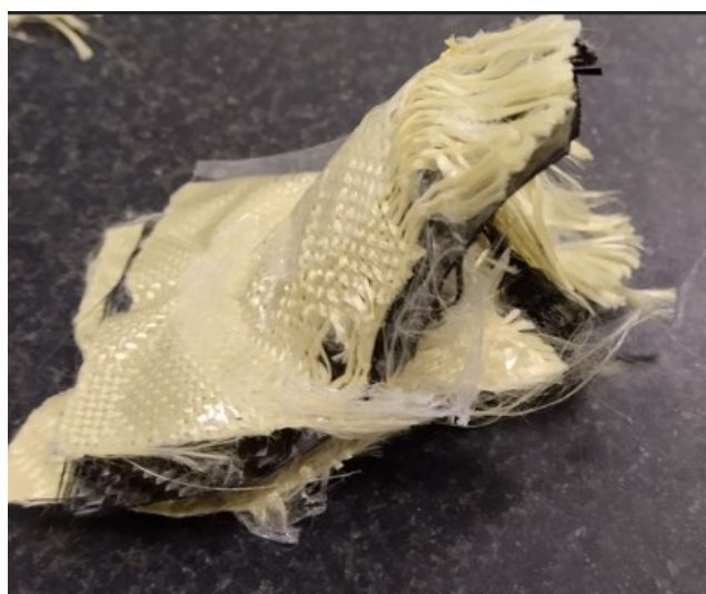
Obrázek 37 Vzorek z kombinace tkanin aramidu a uhlíkové tkaniny [vlastní]
