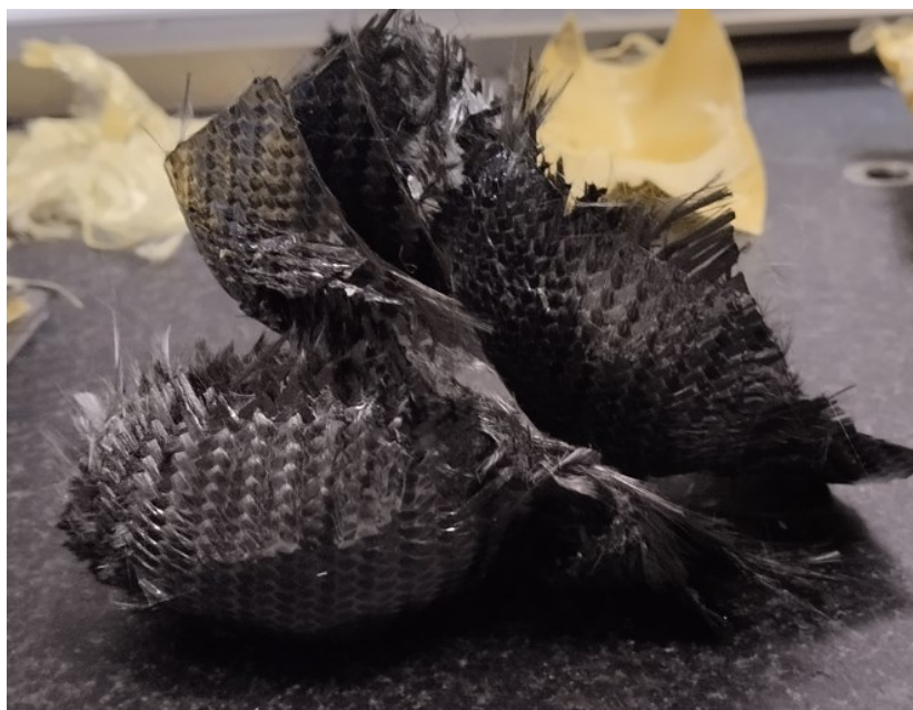
Obrázek 36 Vzorek z 5 vrstev uhlíkové tkaniny [vlastní]
