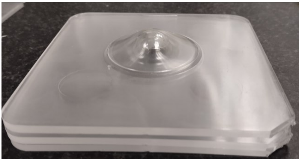
Obrázek 39 Vzorek ze 3 vrstev polykarbonátu [vlastní]
