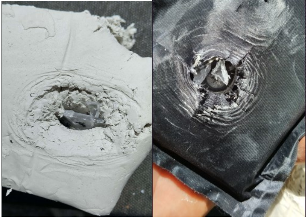
Obrázek 46 Vzorek z polykarbonátu – poškození hmoty [vlastní] Obrázek 47 Vzorek z polykarbonátu – průstřel [vlastní]
