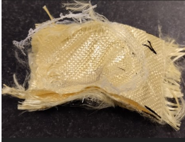
Obrázek 34 Vzorek 5 vrstev aramidové tkaniny style 281 [vlastní]
