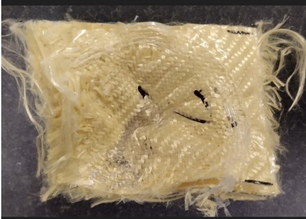
Obrázek 32 Vzorek 5 vrstev z aramidové tkaniny [vlastní]
