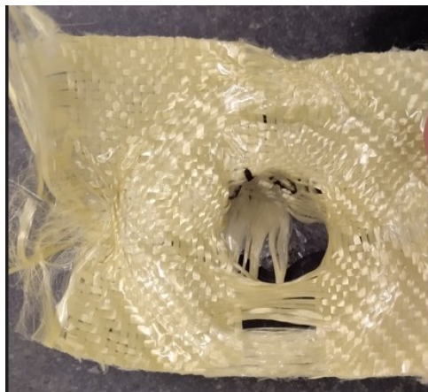
Obrázek 31 Vzorek: samostatné aramidové vlákno [vlastní]
