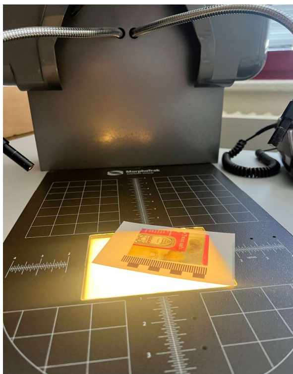
Obrázek 29 Vložení daktyloskopické stopy pod snímací pole přístroje MorphoTrak [vlastní]
