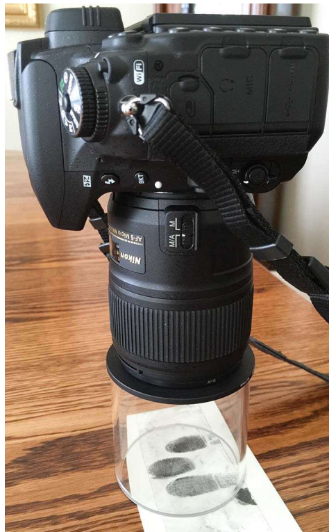
Obrázek 9 Fotografování „tunelem“ daktyloskopické stopy [18]
