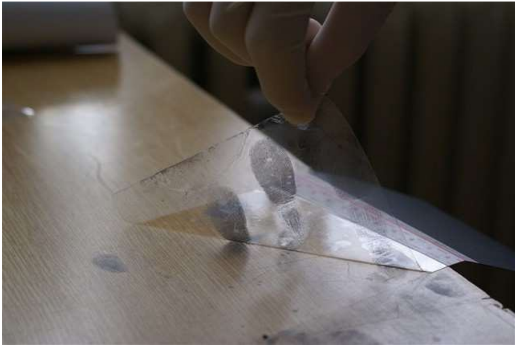
Obrázek 10 Sejmutí daktyloskopických stop průhlednou fólií [19]
