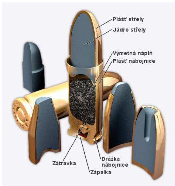
Obrázek 1.: Řez pistolovým nábojem [3]
