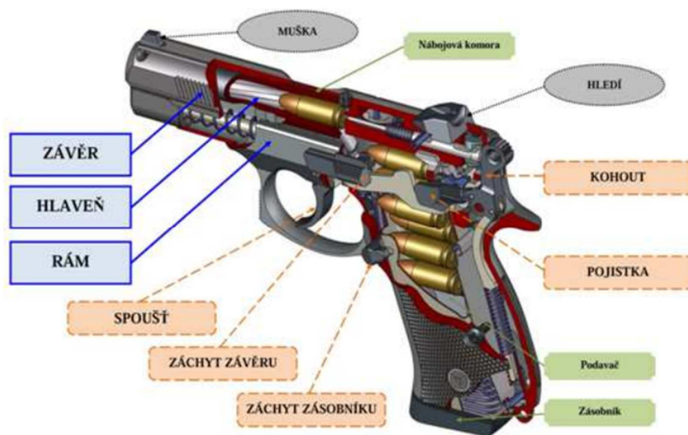
Obrázek 8.: Řez samonabíjecí pistole [14]
