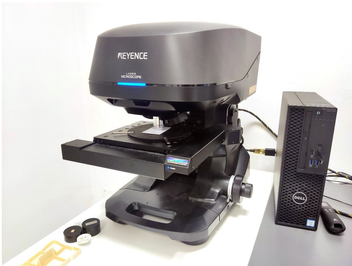
Obrázek 9: 3D laserový skenovací konfokální mikroskop Keyence VK-X1000
