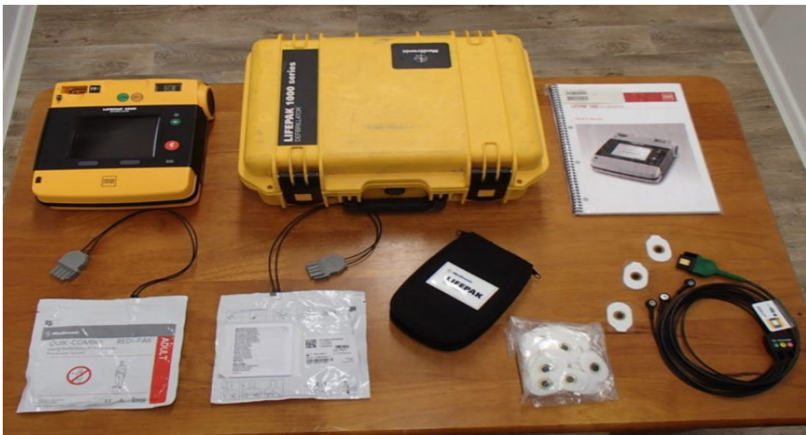
Obrázek 4 Přístroj AED s komponenty (Dušek, 2019)
