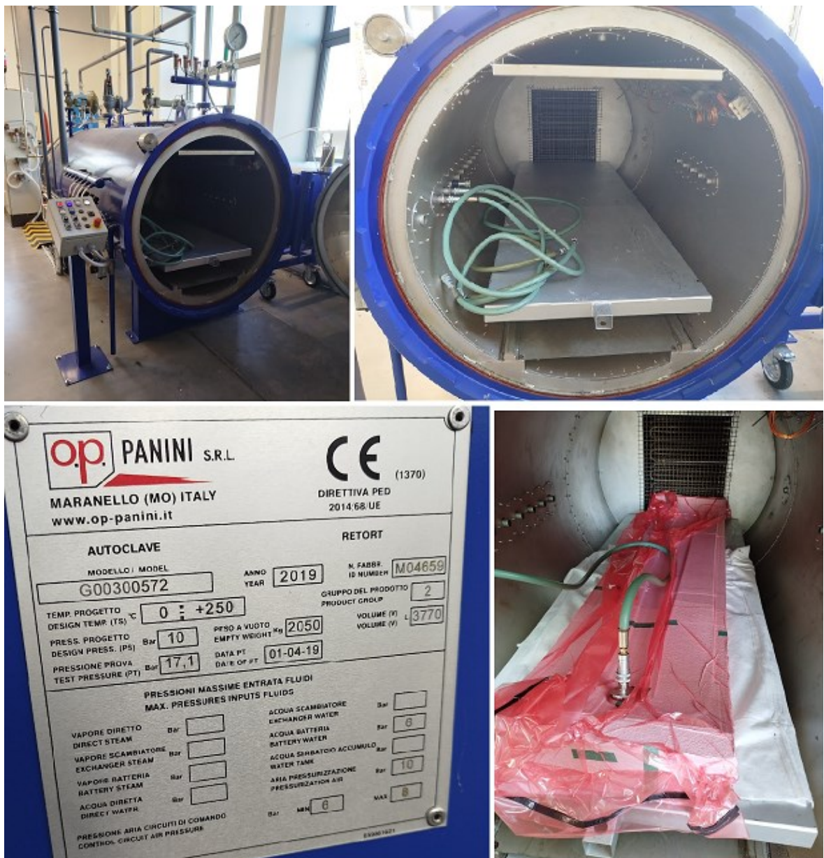
Obrázek 49 Autokláv od italské značky Panini použitý k výrobě lyží
