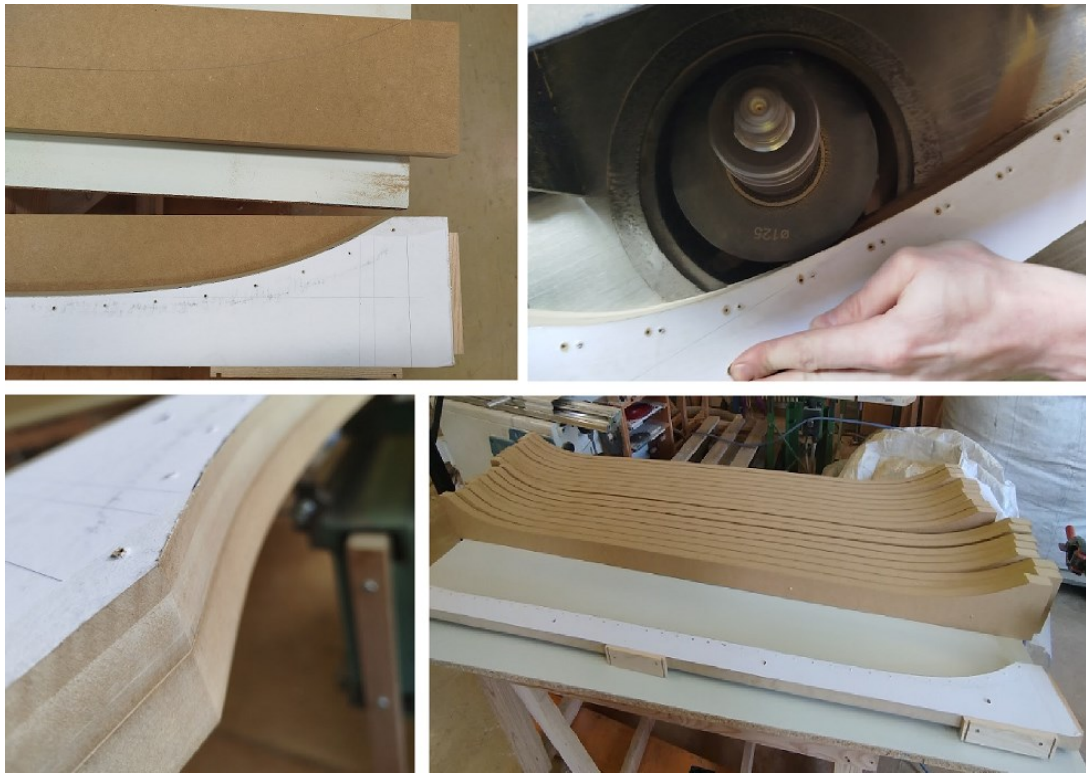
Obrázek 42 Přenesení bočního profilu na ostatní desky pomocí šablony
