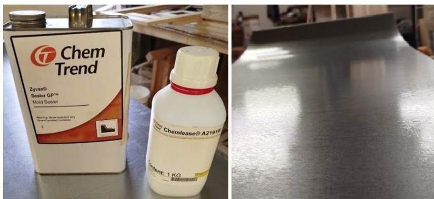
Obrázek 45 Ošetření povrchu formy separační vrstvou
