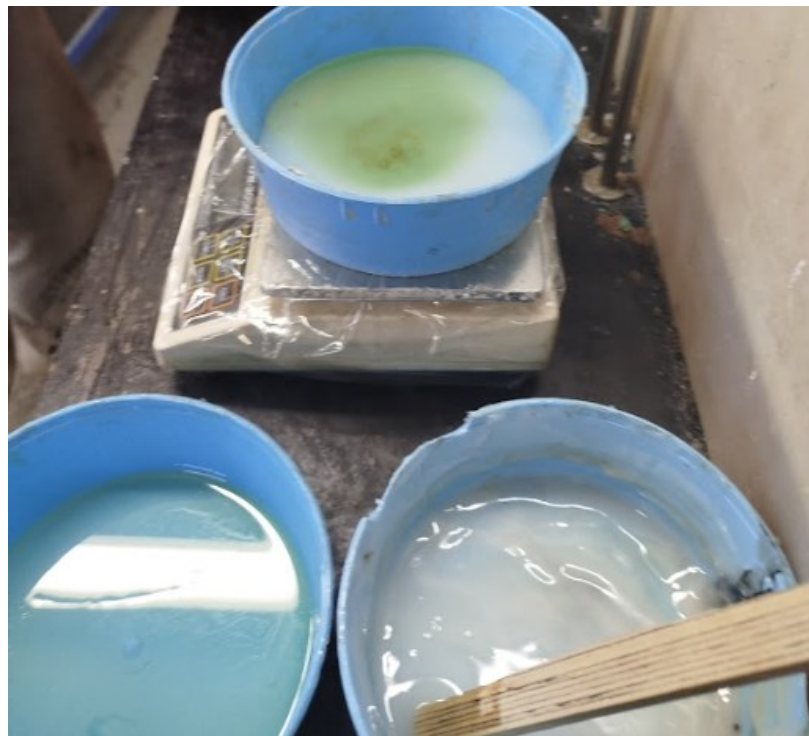
Obrázek 35 Epoxidová pryskyřice použitá při výrobě lyží
