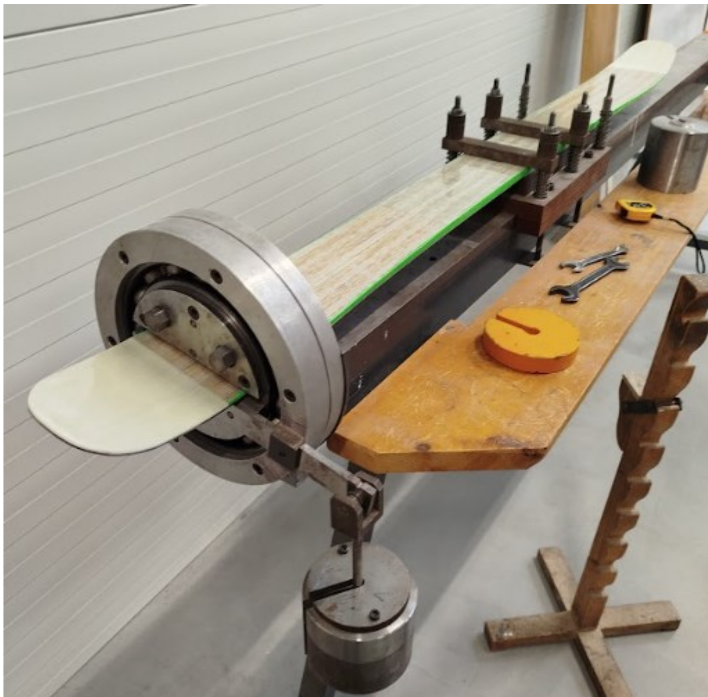
Obrázek 63 Zařízení na měření torzní tuhosti lyží
