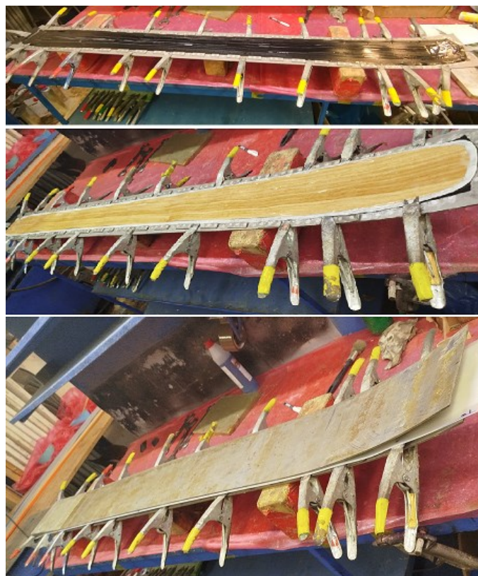
Obrázek 56 Kladení jednotlivých vrstev lyže do formy pro vložení do lisu
