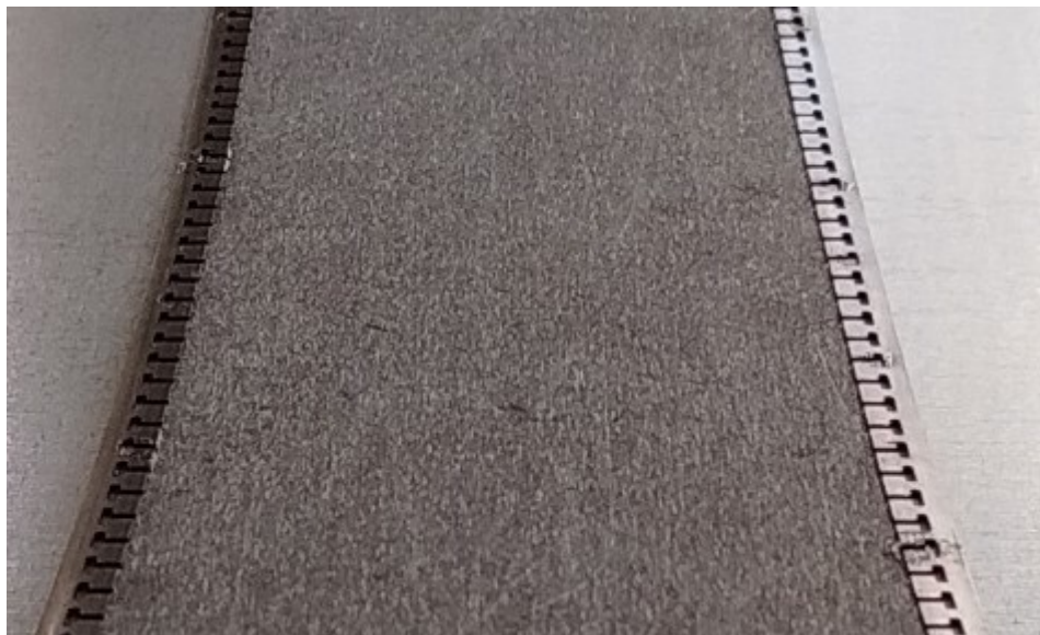
Obrázek 27 Sintrovaná skluznice použitá k výrobě lyží
