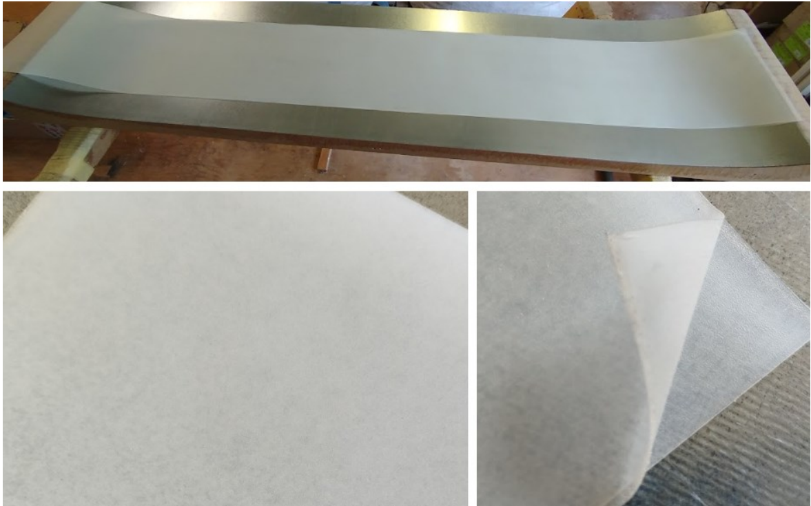
Obrázek 31 Transparentní horní fólie (topsheet) použitá pro výrobu lyží
