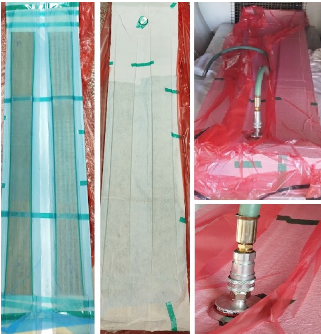
Obrázek 48 Zabalení formy s lyžemi do ochranných vrstev a vakuového pytle
