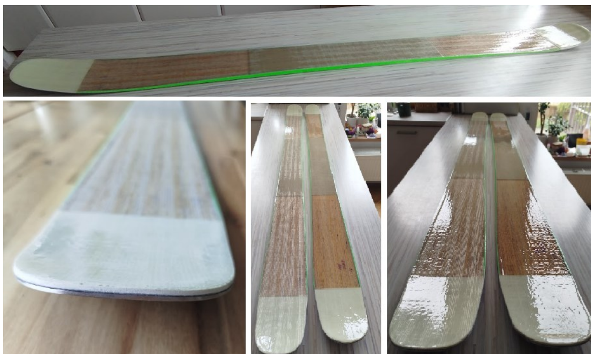
Obrázek 55 Finální podoba vyrobených lyží pomocí technologie zpracování v autoklávu
