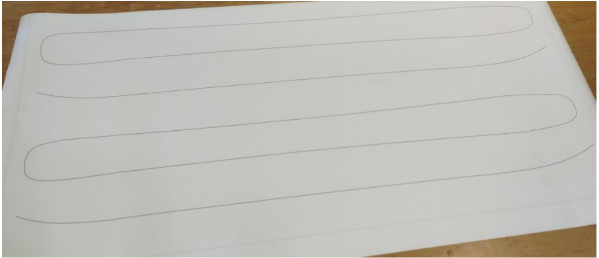
Obrázek 38 Výkres lyží vytištěný na papír v měřítku 1:1
