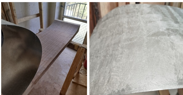
Obrázek 44 Nalepení plechu na povrch formy za použití kontaktního lepidla ve spreji
