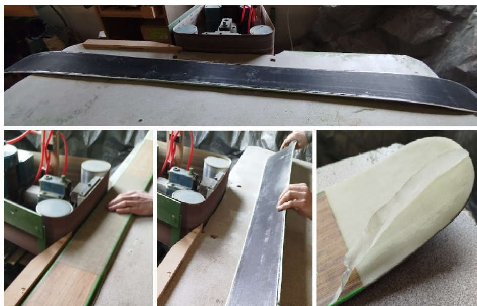
Obrázek 53 Broušení přebytečného materiálu na stolní brusce a sundání ochranné fólie
