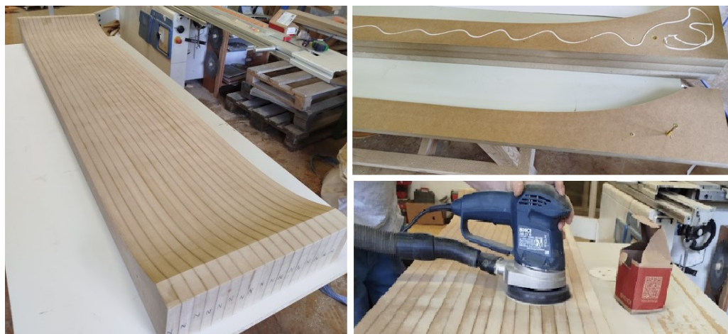
Obrázek 43 Spojení jednotlivých desek formy pomocí lepidla a vrutů a vybroušení nerovností
