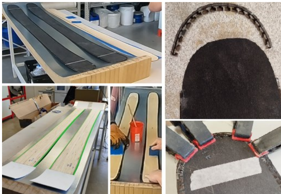
Obrázek 47 Kladení vrstev sendvičové konstrukce lyže, roztírání pryskyřice a lepení hran
