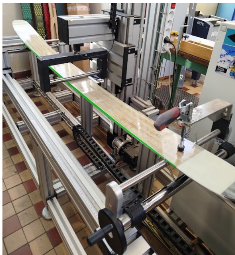
Obrázek 62 Prohnutá lyže v průběhu měření pružnosti
