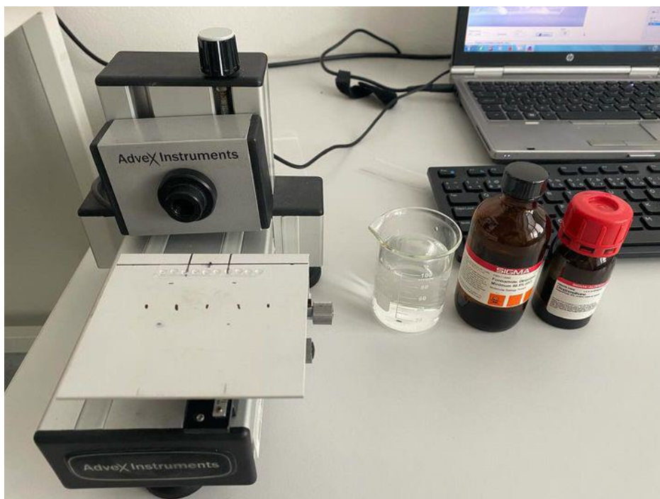
Obrázek 7 Příklad přístroje See system E s použitými kapalinami (voda, formamid, diiodomethan)
