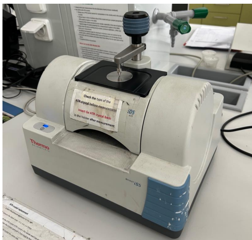
Obrázek 12 Přístroj pro měření ATR-FTIR Nicolet iS5 (Thermo-fisher Scientific)
