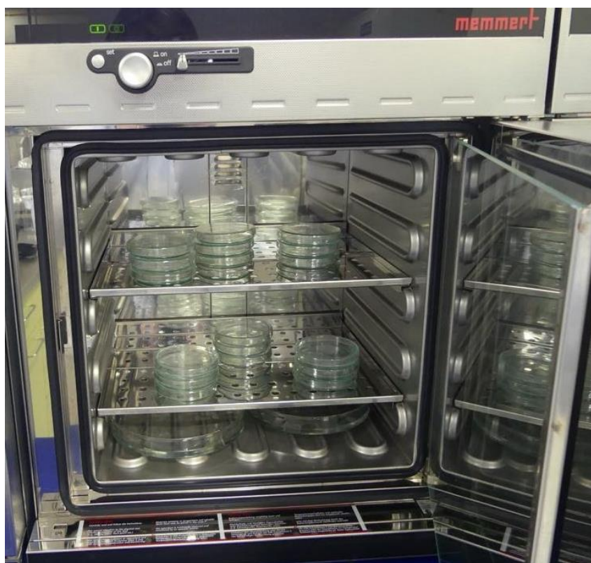
Obrázek 14 Inkubátor INB 400 (Mettler) použitý při testech antibakteriální aktivity
