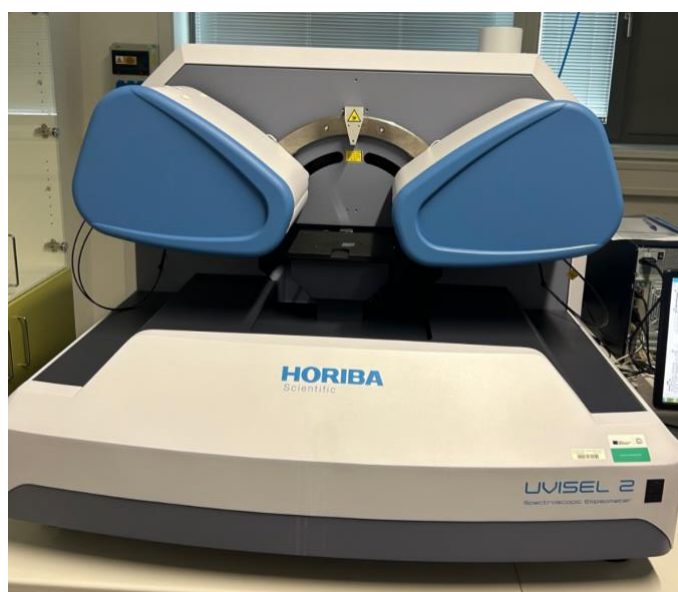
Obrázek 11 Přístroj pro spektroskopickou elipsometrii Horiba uvisel 2
