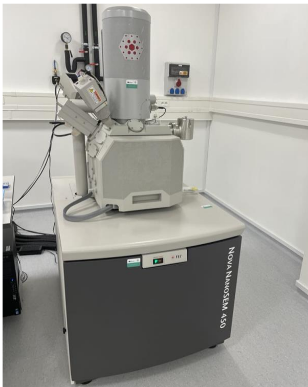
Obrázek 9 Skenovací elektronový mikroskop Nova NanoSEM 450 (FEI, Hillsboro, OR, USA)
