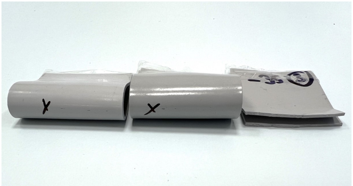
Obrázek 33: Příklady poškození při zkoušce ohybu za nízkých teplot
