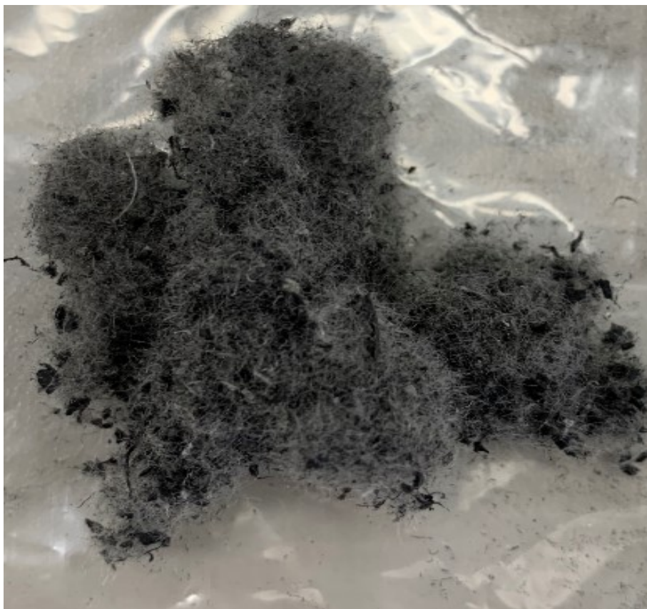
Obrázek 15: Získaná směs PES vláken a PVC drti
