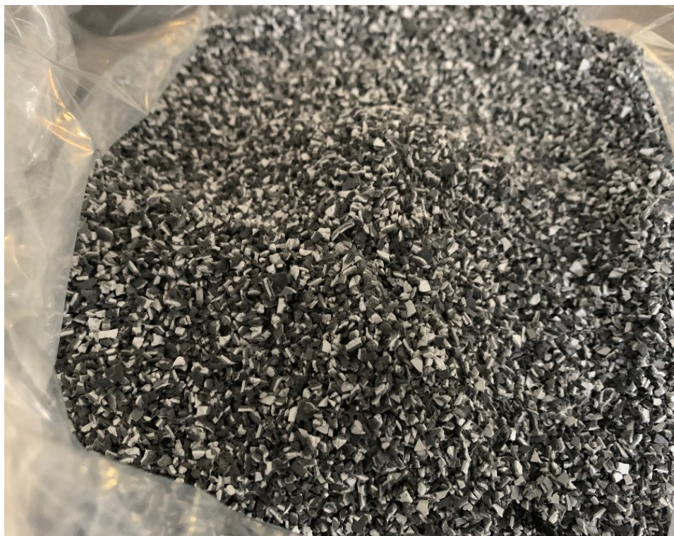
Obrázek 14: PVC drť získaná po separaci PES vláken
