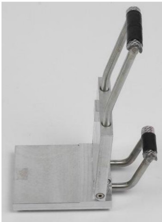
Obrázek 32: Zkušební přístroj pro testování ohybu za nízkých teplot [51]
