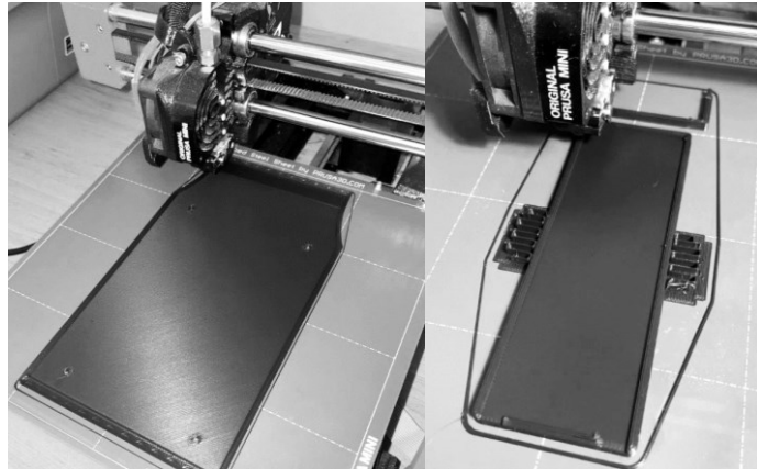
Obrázek 68 – Průběh 3D tisku spodního krytu a držáku baterie
