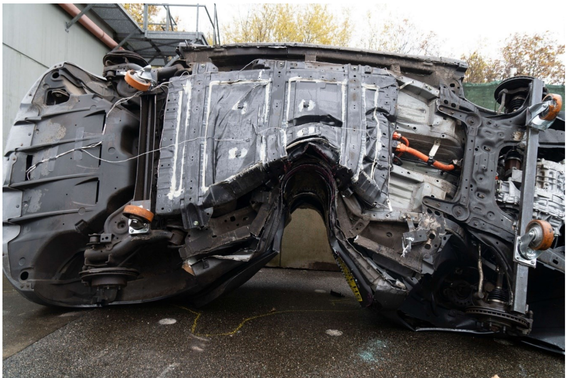
Obrázek 20 Silně zdeformovaná baterie Nissanu Leaf (DEKRA, 2019)
