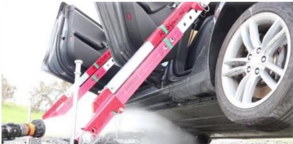
Obrázek 24 Polohování vozidla při chlazení baterie (Aktuální poznatky z elektromobility pro potřeby HZS ČR, 2020)
