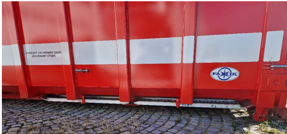
Obrázek 36 Ocelové nájezdy pro lepší přístupnost (Vlastní, 2023)
