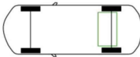
Obrázek 17 Konfigurace trakční baterie v zadní části vozidla (Research Institutes of Sweden, 2019)
