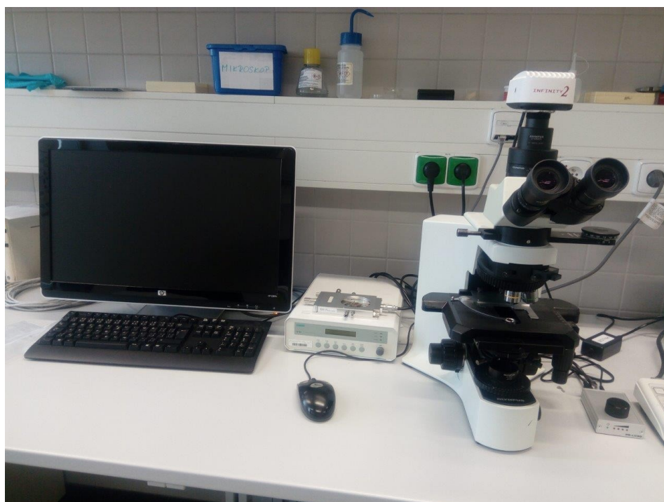
Obr. 25 Optický mikroskop Olympus BX41 [45]
