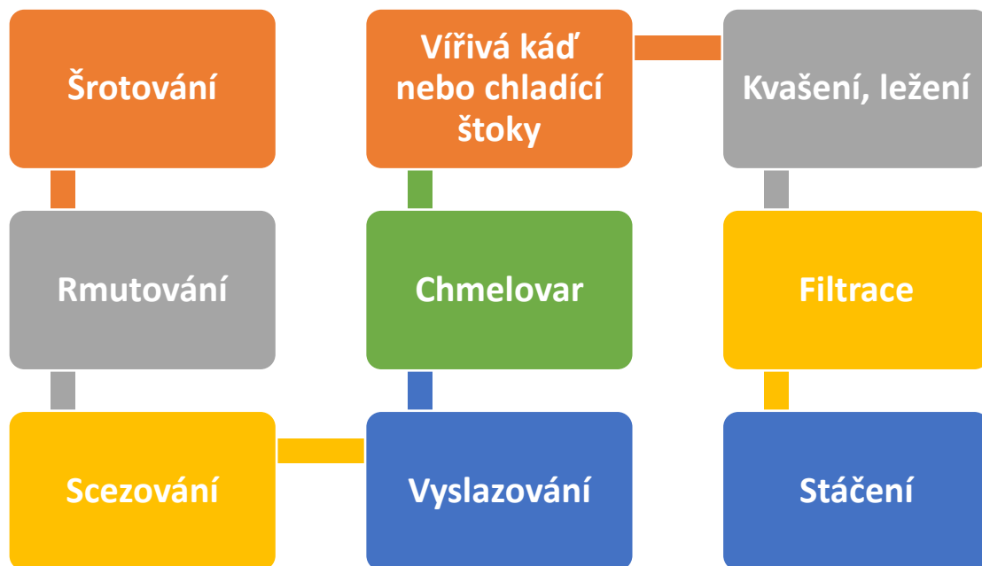
Obrázek 8 Postup výroby piva (Vlastní zpracování)
