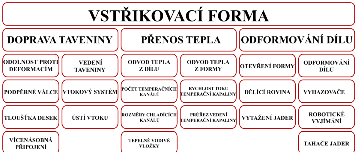
Obrázek 17 Funkce vstřikovací formy [23]
