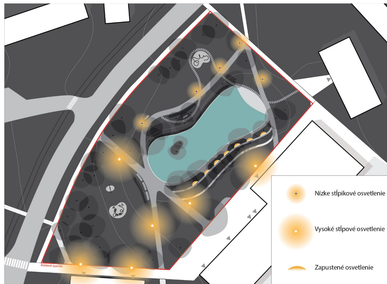
Obrázok 17 Schéma navrhovaného osvetlenia (Vlastný zdroj)
