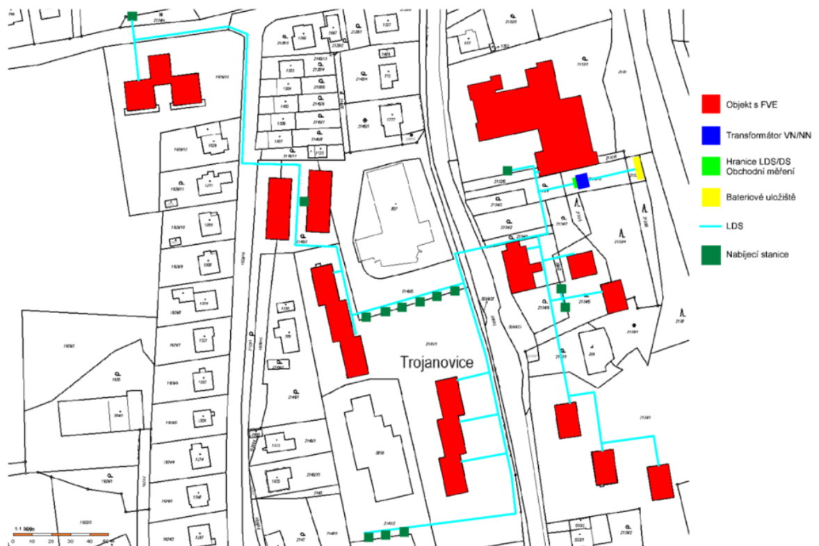
Obrázek 10 Koncepce lokální distribuční sítě a umístění technologií (Obec 2030, 2023)
