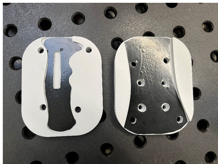
Obrázek 33 Držák pro zavírací kapesní nůž [vlastní zdroj]
