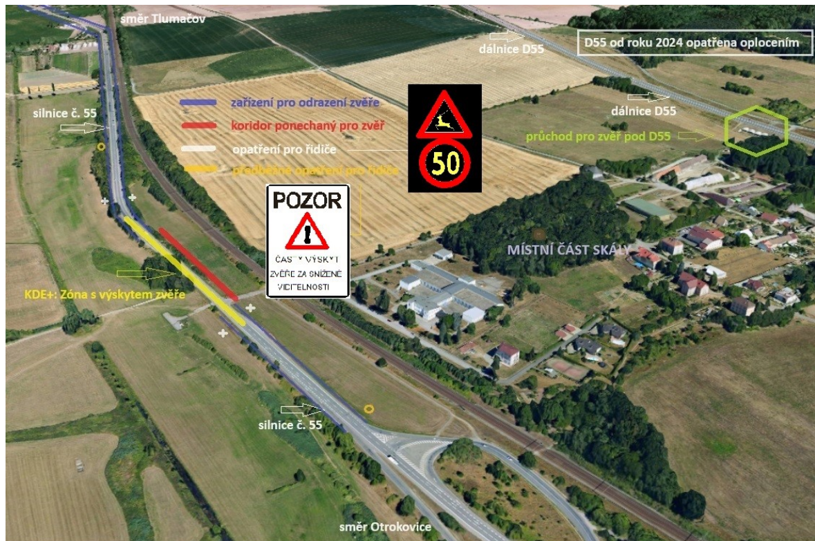
Obrázek 21 Mapa oblasti mezi Otrokovicemi a Tlumačovem s vyznačením „koridorů pro zvěř“, opatření proti vstupu zvěře a umístěním dopravních značek.
