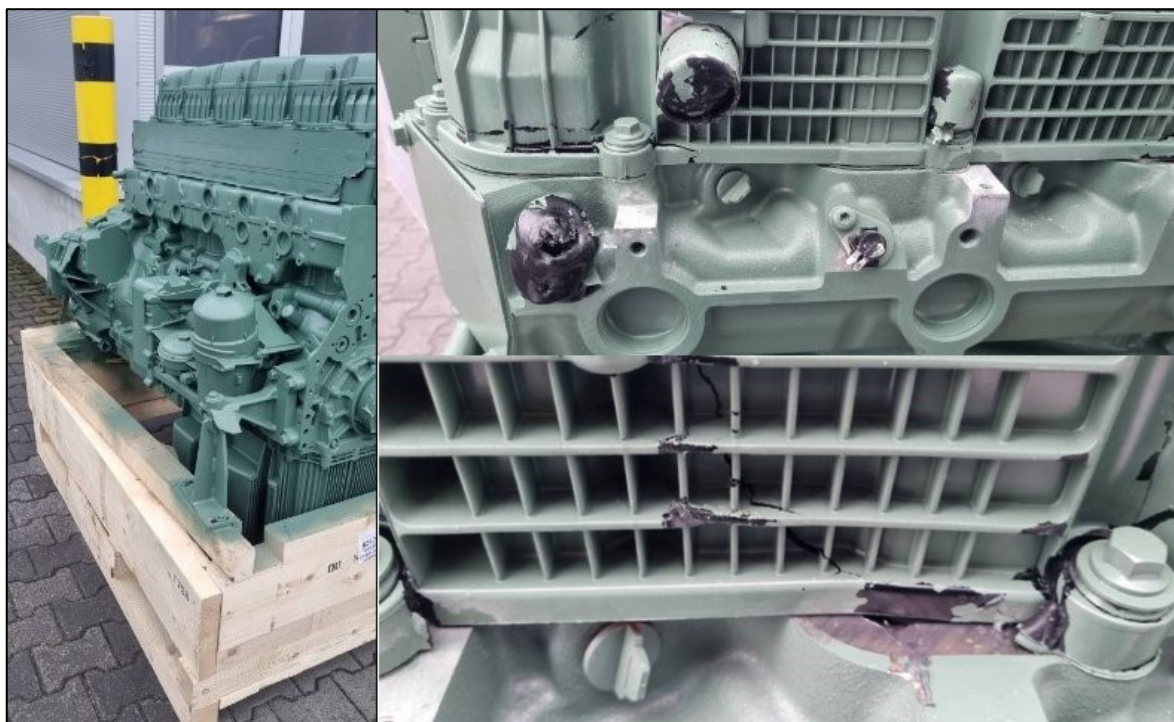
Obrázok 11 Poškodený motor nákladného auta (zdroj: vlastné spracovanie podľa podkladov firmy)
