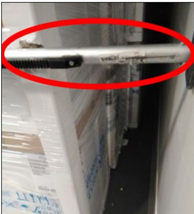
Obrázok 8 Poškodenie transportom rozpernou tyčou (zdroj: vlastné spracovanie podľa podkladov firmy)
