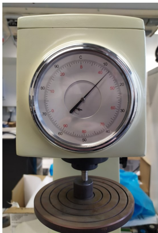
Obr. 31 Analogová stupnice použitého tvrdoměru
