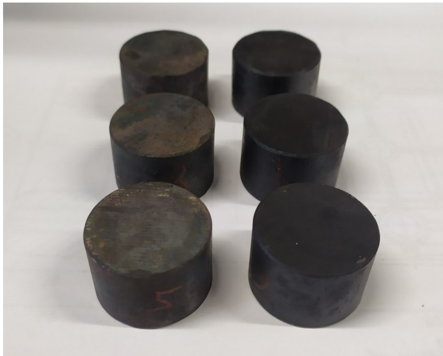
Obr. 29 Zakalené vzorky, vlevo ve vodě, vpravo v oleji
