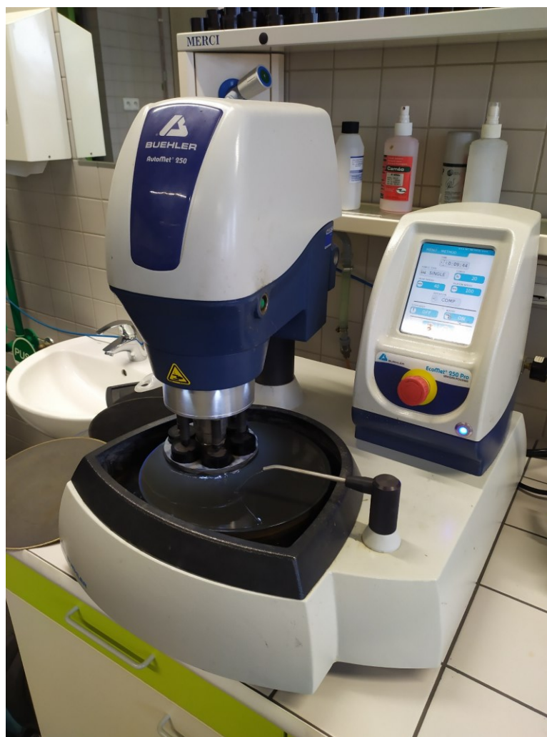
Obr. 33 Metalografická bruska/leštička Buehler AutoMet 250
